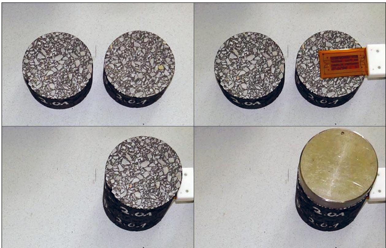
Bild 7-4: MPK SMA-2 mit plangeschliffenen Schnittkreisflächen (o. l.), Platzierung des Messensors auf der Oberfläche (o. r.), Platzierung des Messensors zwischen zwei Marschallprobekörpern (u. l.), Belastung der Probekörper durch Stempel (u. r.)
