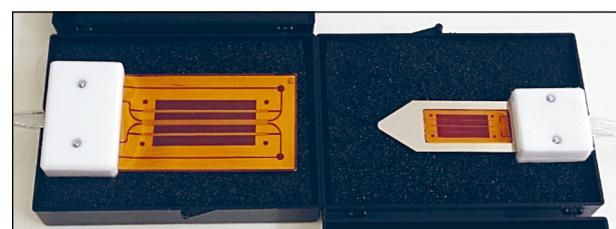
Bild 7-3: Sensoren THB 6N (82 x 42 mm) links und THB6K/MFR (42 x 22 mm) mit Metallrahmen rechts
