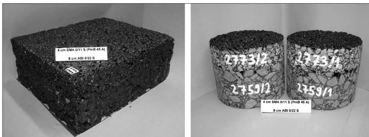
Bild 43: Plattenpaket und daraus entnommene Bohrkern
