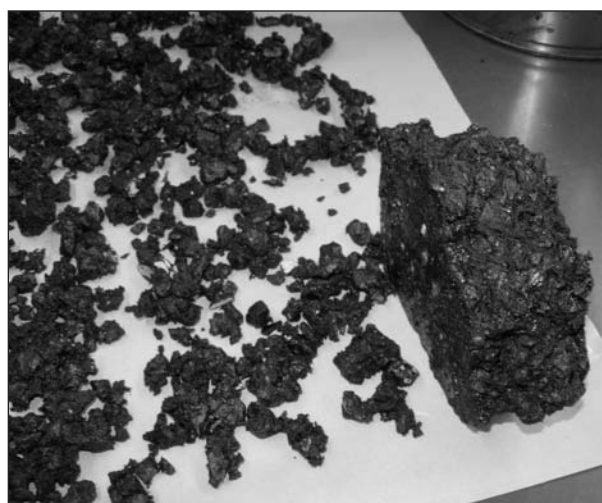
Bild 52: Granulierung eines Probekörpers aus Epoxy Asphalt
