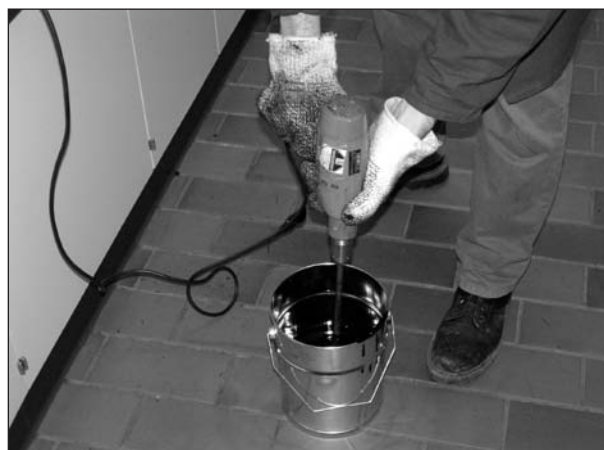
Bild 14: Vermischen von Bitumen und Epoxydharz
