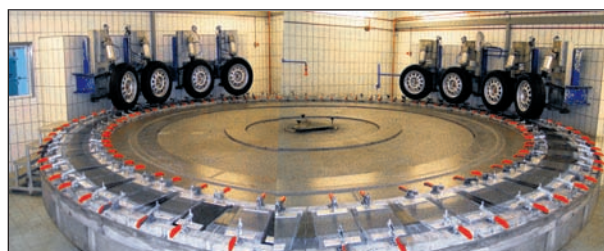
Bild 66: Rundlaufprüfanlage der BASt (Fotomontage)
