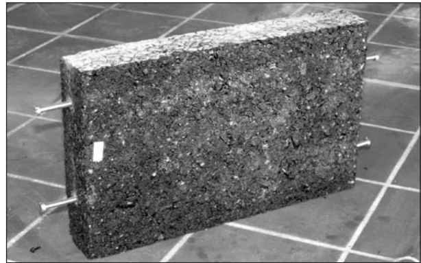
Bild 67: WSV-Platte mit beschnittenen Längsseiten und eingesetzten Schrauben
