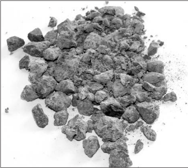
Bild 53: Gesteinskörnungsgemisch aus extrahiertem Epoxy Asphalt
