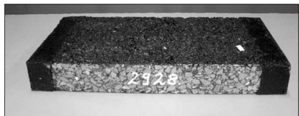
Bild 68: Fertiger Probekörper für die Prüfung in der RPA
