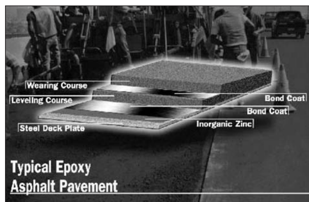
Bild 8: Schichtenaufbau eines Brückenbelages aus Epoxy Asphalt [5]
