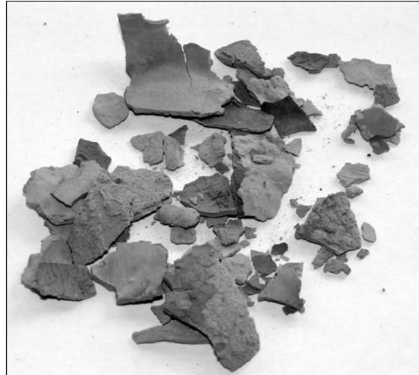
Bild 54: Füller aus extrahiertem Epoxy Asphalt
