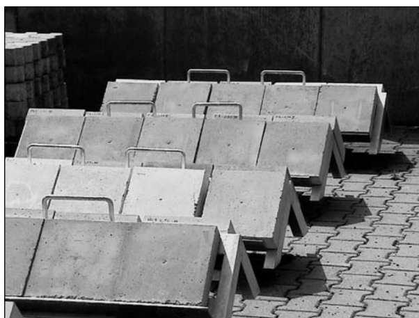
Bild 7: Gestelle zur Freibewitterung der hydrophobierten Probeplatten. Die Gestelle stehen transportbereit auf Paletten
