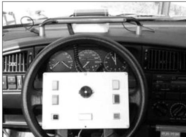
Bild 12: A12 + A13 Reiz-Reaktions-Testgerät
