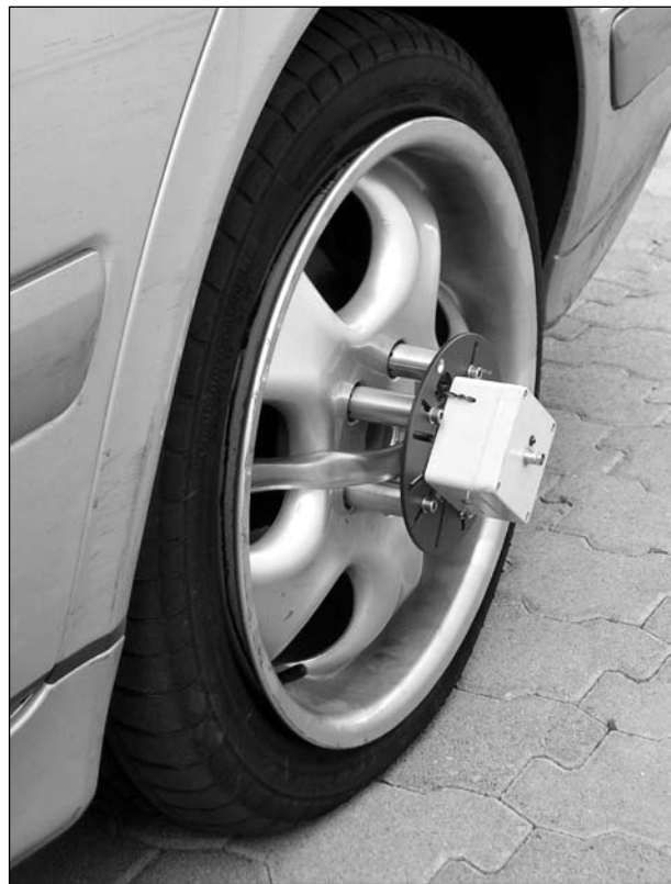
Bild 3.2: Ventileinheit zur Schnellentlüftung
