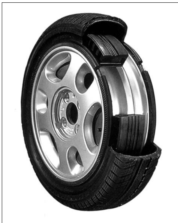
Bild 2.3: Aufgeschnittener Michelin PAX-Reifen (Quelle: Michelin)
