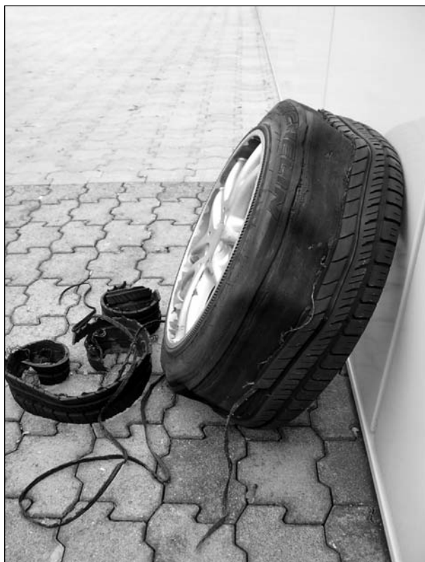
Bild 3.15: Laufflächenablösung durch hohe Beanspruchung bei stationärer Kreisfahrt
