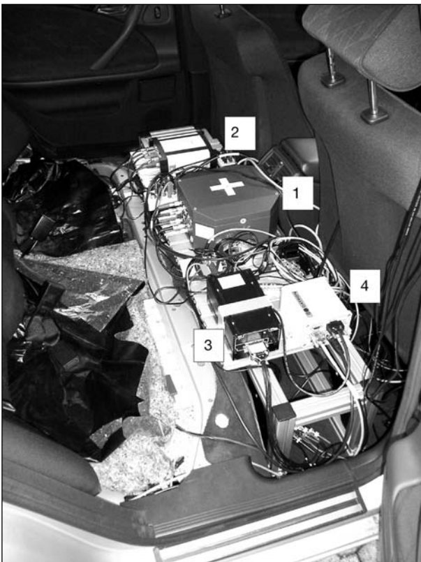
Bild 3.1: Fahrzeuginstrumentierung, bestehend aus Kreisel-system (1), GPS-Empfänger mit Funkmodem (2) sowie Elektronikeinheiten für das Messlenkrad (3) und Geschwindigkeitssensor (4)
