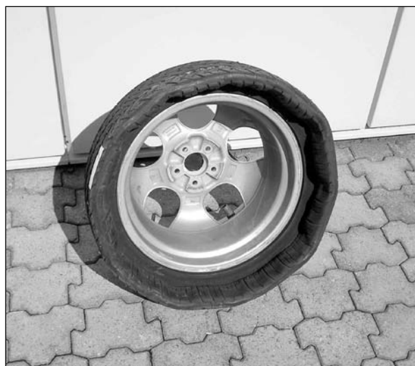
Bild 3.18: Nach innen gestülpter Reifen nach Messfahrt mit Schnellentlüftung
