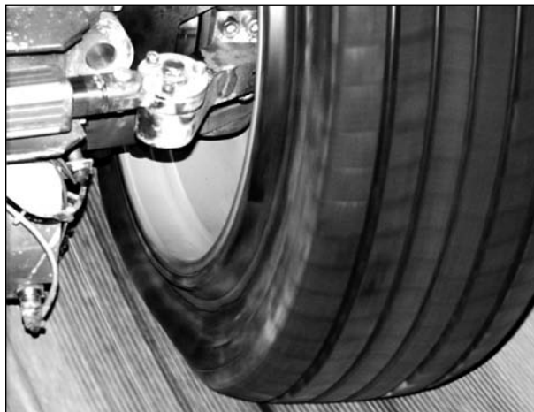
Bild 4.8: Der Reifen A in drucklosem Zustand, belastet mit 5.250 N, bei v = 80 km/h während einer Lenkbewegung
