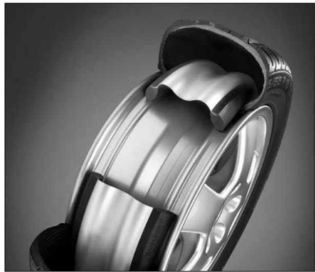
Bild 2.1: ContiSupportRing: Zur Gewährleistung der Notlaufeigenschaften besitzt das Rad einen auf der Felge liegenden Metallring mit flexibler Auflage, der zusammen mit Standardreifen und -felgen montiert werden kann (Quelle: Continental)
