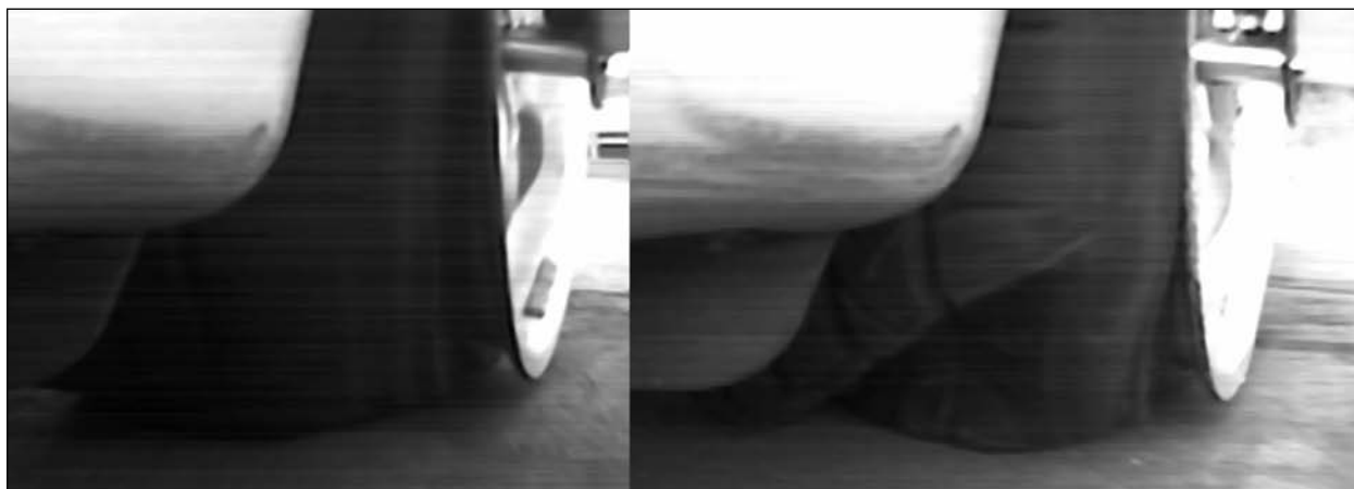
Bild 3.17: Verformung des Reifens nach plötzlichem Luftverlust
