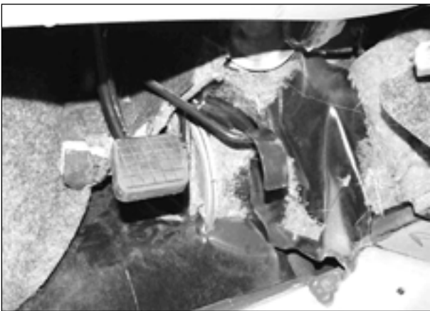
Bild 6.21: Eintrittsstelle der Getrieberiemenscheibe unterhalb des Gaspedals
