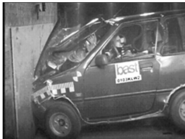
Bild 6.29: Videoaufnahme: Aufprall des Kopfes auf das Lenkrad. Man erkennt das weit in den Innenraum geschobene Lenkrad
