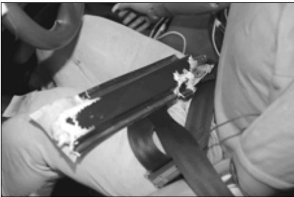
Bild 6.14b: Ausgerissene B-Säule des Bellier-Gebrauchtfahrzeugs
