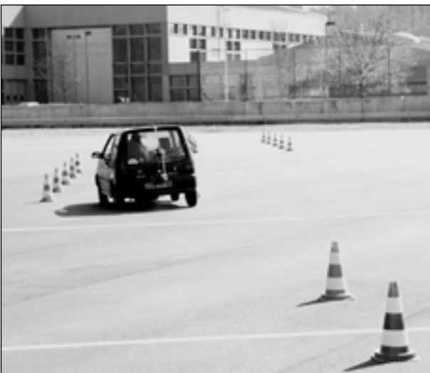
Bild 5.14: Doppelter Spurwechsel mit Leichtkraftfahrzeug
