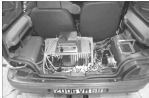
Bild 6.1: Fahrzeug mit eingebautem Encoder K3600
