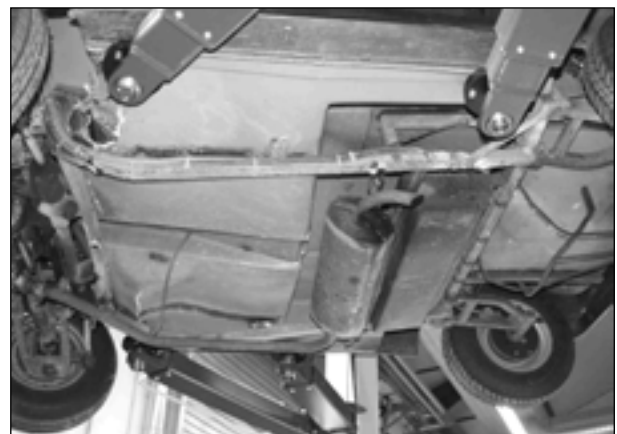
Bild 6.13: Verformung des Unterbodenrahmens
