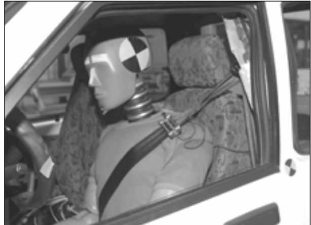
Bild 6.8a: Ausgerissene Gurtverankerung beim Bellier-Neufahrzeug
