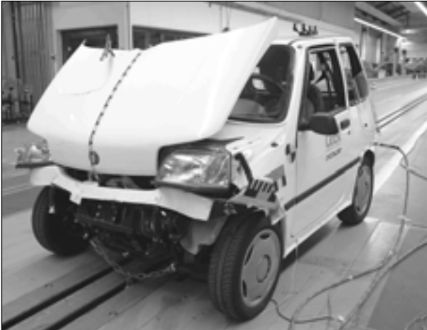
Bild 6.6: Bellier-Neufahrzeug; Frontcrash mit 35 km/h vor eine starre Wand; 100 % Überdeckung
