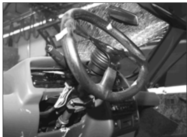
Bild 6.9: Gesamtansicht des Cockpits nach dem Crash des Bellier-Neufahrzeugs. Das Lenkrad wurde durch Brust- und Kopfkontakt erheblich deformiert
