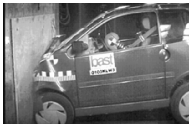
Bild 6.30: Videoaufnahme: Aufprall des Dummies auf die Prallplatte am Lenkrad
