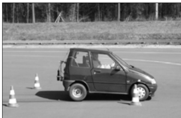
Bild 5.5: Bremsung geradeaus mit gebrauchtem LKfz Bellier (Baujahr 1994)
