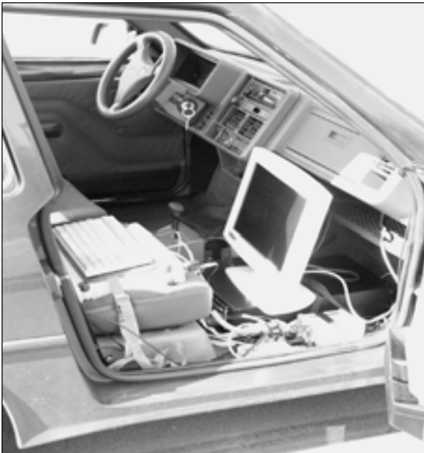
Bild 5.1: Mit Datenerfassungssystem ausgerüstetes Leichtkraftfahrzeug
