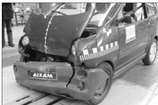
Bild 6.18: Aixam; Frontcrash mit 35 km/h vor eine starre Wand; 100 % Überdeckung
