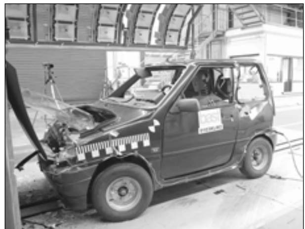
Bild 6.12: Bellier-Gebrauchsfahrzeug; Frontcrash mit 35 km/h vor eine starre Wand; 100 % Überdeckung
