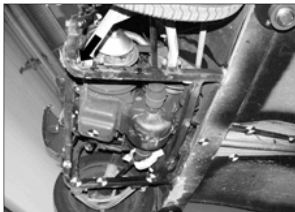
Bild 6.19d: Verformungen des Vorderwagens nach dem Crash
