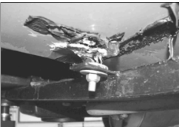
Bild 6.7b: Ausgerissene Schraubverbindung im Unterboden des Bellier-Neufahrzeugs
