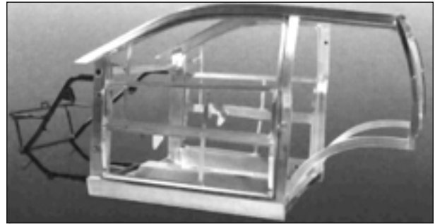
Bild 6.4: Aluminiumkarosserie des Aixam mit Vorderwagengestell aus Stahlprofilen
