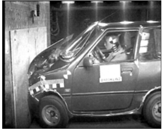
Bild 6.15: Videoaufnahme: Crashverhalten des Bellier-Gebrauchtfahrzeugs beim Einreißen der B-Säule. Man erkennt eine Stauchung der B-Säule auf Grund der Fortpflanzung des Crashpulses durch die Karosserie
