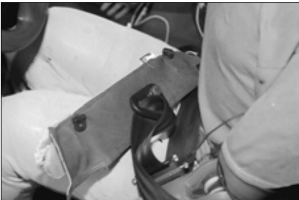
Bild 6.14c: Ausgerissene B-Säule des Bellier-Gebrauchtfahrzeugs
