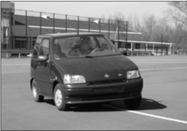
Bild 5.12: Stationäre Kreisfahrt mit LKfz Bellier (Baujahr 1994)
