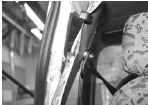
Bild 6.8b: Ausgerissene Gurtverankerung beim Bellier-Neufahrzeug
