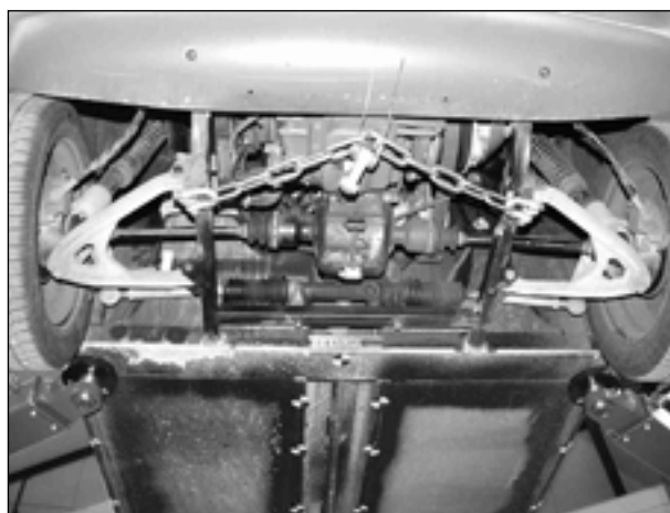
Bild 6.19a: Vorderwagen des Aixam vor dem Crash
