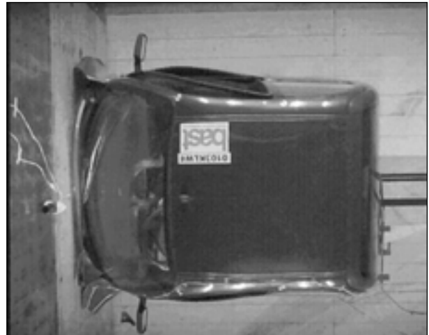
Bild 6.28: Videoaufnahme im Moment der maximalen Längsdeformation: Das Bild zeigt den Kontakt des oberen Querträgers an der Stirnseite der Fahrgastzelle mit dem Block. Dieser Deformationsbereich zeichnet sich durch eine hohe Steifigkeit aus und soll den Fahrer z. B. beim Aufprall auf eine Mauer schützen. Es ist jedoch zu bedenken, dass dieser „Sicherheitsbereich“ bereits bei einer Aufprallgeschwindigkeit von 35 km/h in Mitleidenschaft gezogen wurde
