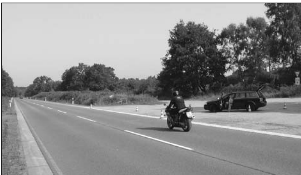
Bild 6.2: Durchführung der Fahrgeräuschmessung „light“
