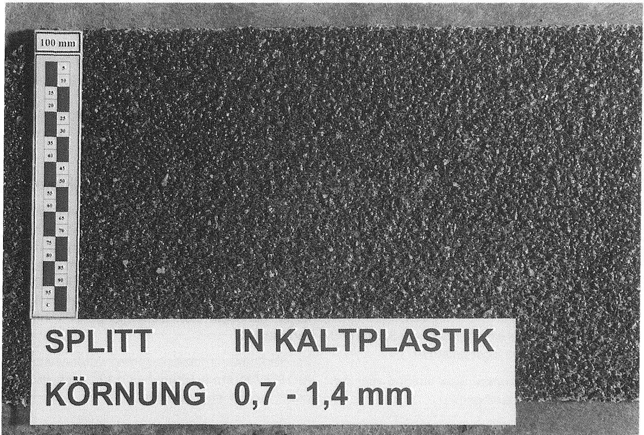
Bild 4.12: Dünnschichtbelag Splitt in Kaltplastik 0,7 – 1,4 mm, aufgestreut
