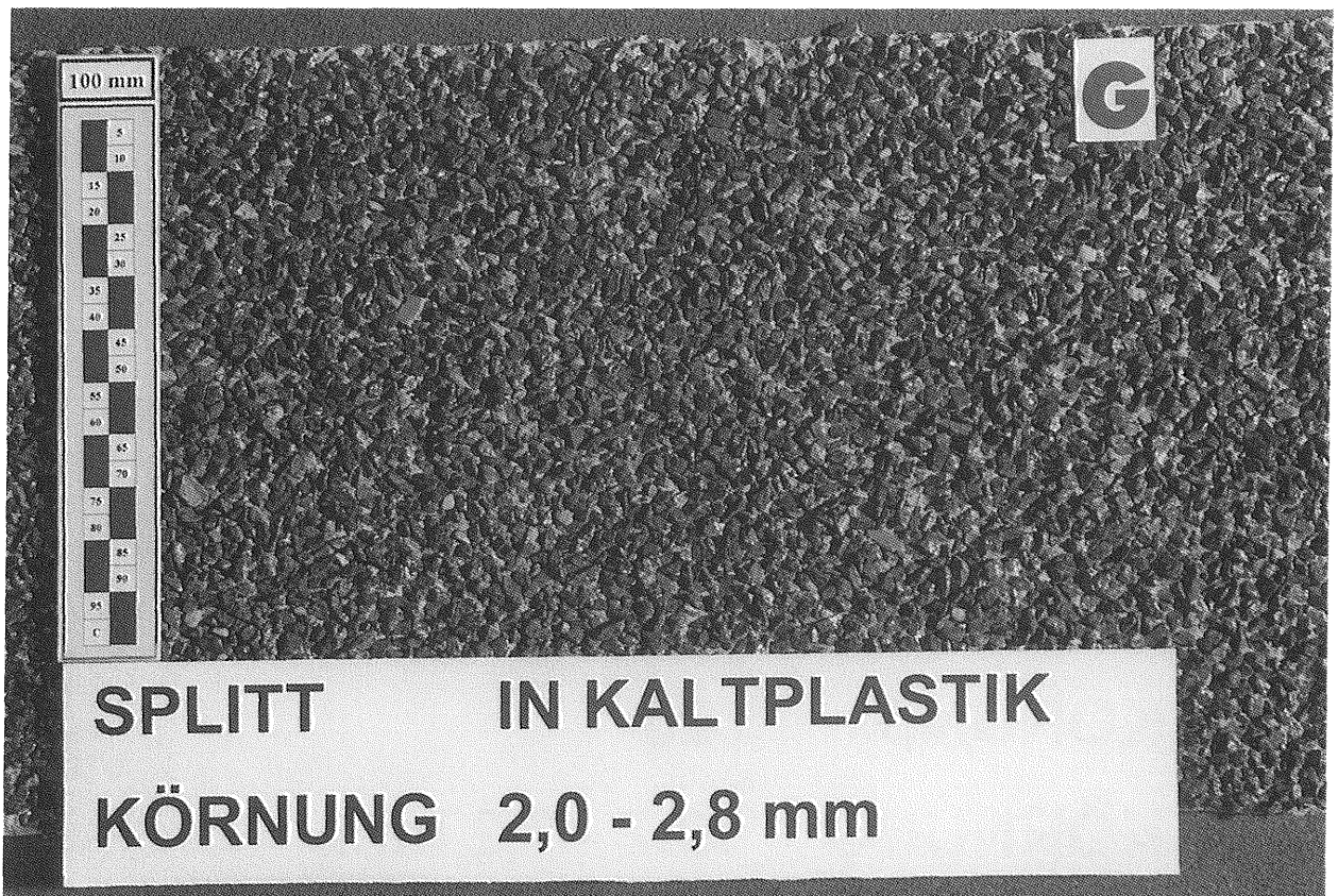
Bild 4.8: Dünnschichtbelag Splitt in Kaltplastik 2,0–2,8 mm, gewalzt
