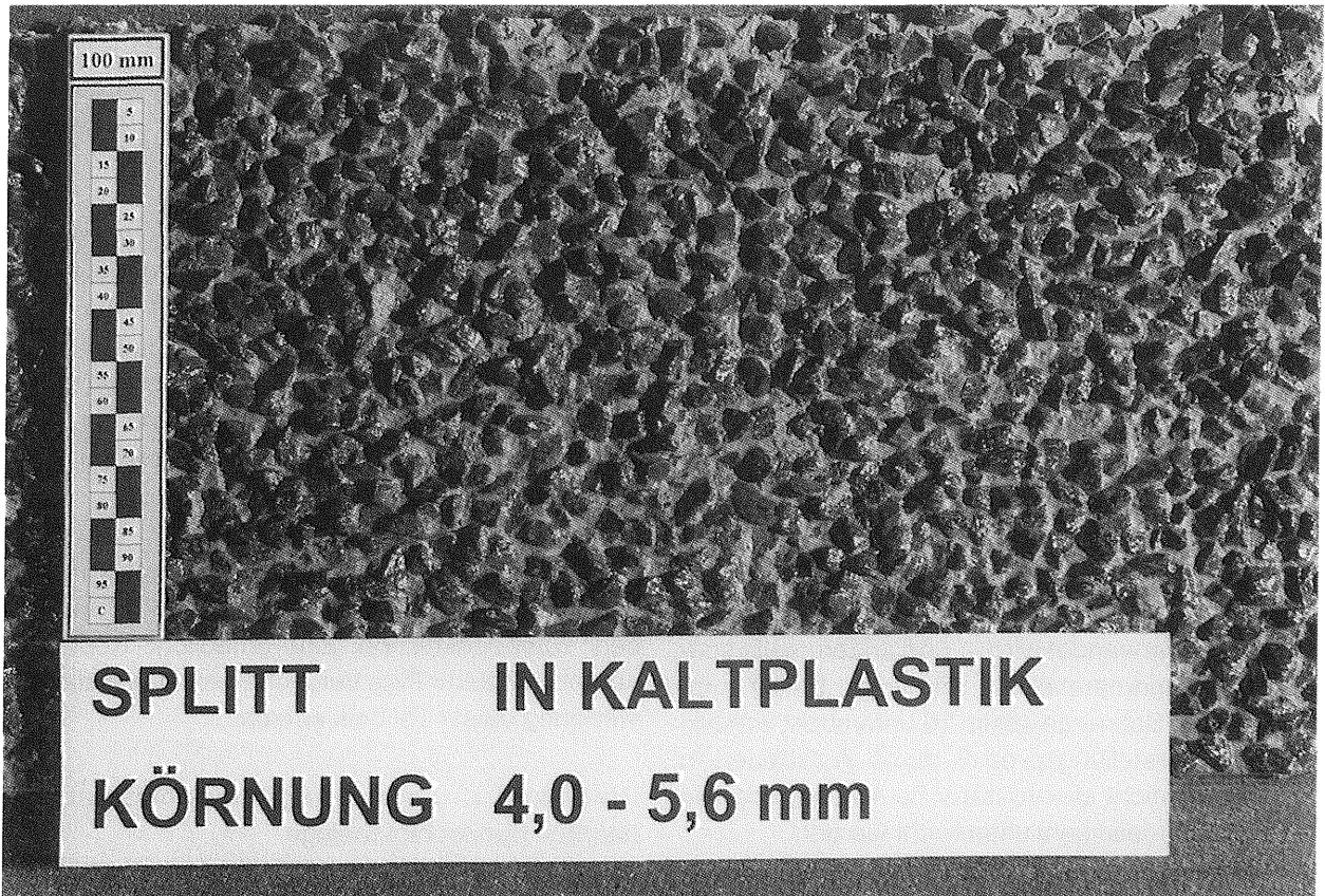
Bild 4.10: Dünnschichtbelag Splitt in Kaltplastik 4,0–5,6 mm, aufgestreut
