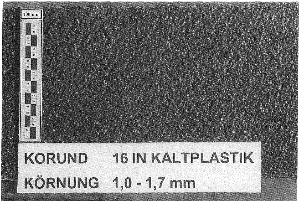
Bild 4.13: Dünnschichtbelag Korund in Kaltplastik, Körnung 1,0 – 1,7 mm, aufgestreut
