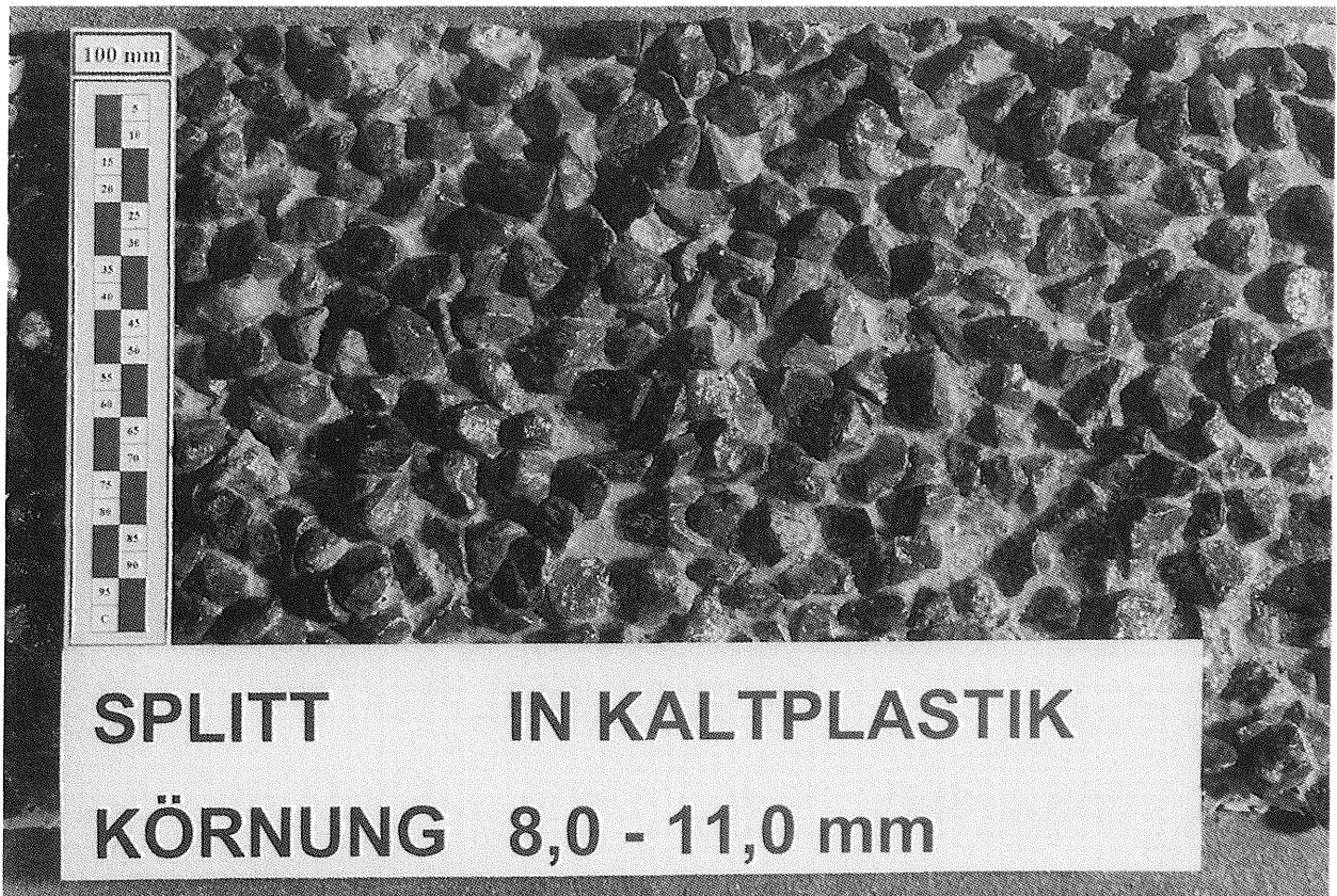
Bild 4.11: Dünnschichtbelag Splitt in Kaltplastik 8–11 mm, aufgestreut
