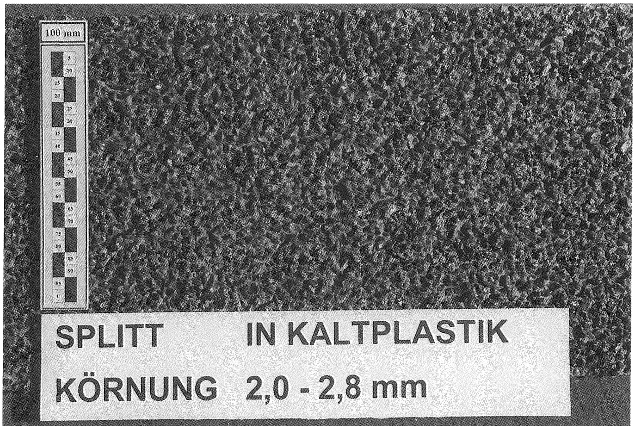
Bild 4.9: Dünnschichtbelag Splitt in Kaltplastik 2,0–2,8 mm, aufgestreut
