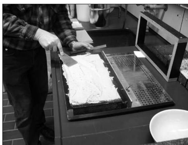
Bild 8: Applizieren des Mörtels auf die Asphaltplatte
