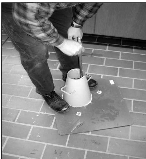
Bild 4: Herstellung des Frischmörtelkegels zur Setzmaßbestimmung
