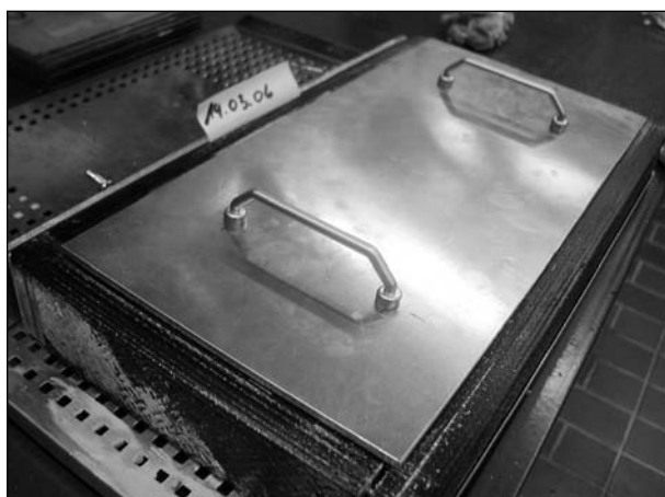
Bild 13: Eindrücken der Körner in die Mörtelschicht mit einer Aluminiumplatte
