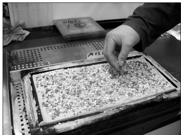
Bild 12: Gleichmäßiges Aufstreuen der Gesteinskörnung mit Hand
