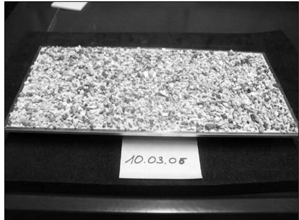
Bild 10: Bauxit (4 kg/m 2 ) auf einer klebenden Aluminiumplatte
