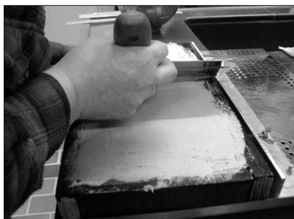
Bild 9: Abziehen der Mörteloberfläche mit breitem Spachtel
