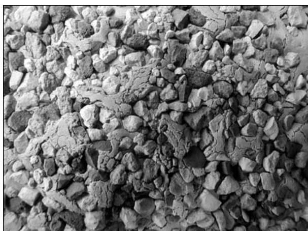
Bild 15: Abgestreute Probepplatten mit trockener Gesteinskörnung
