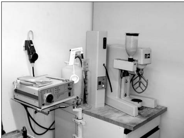
Bild 1: Mörtelmischer DIN EN 196-1 [6]
