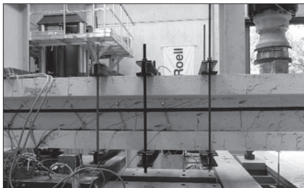
Bild 23: Verstärkung des Trägers
