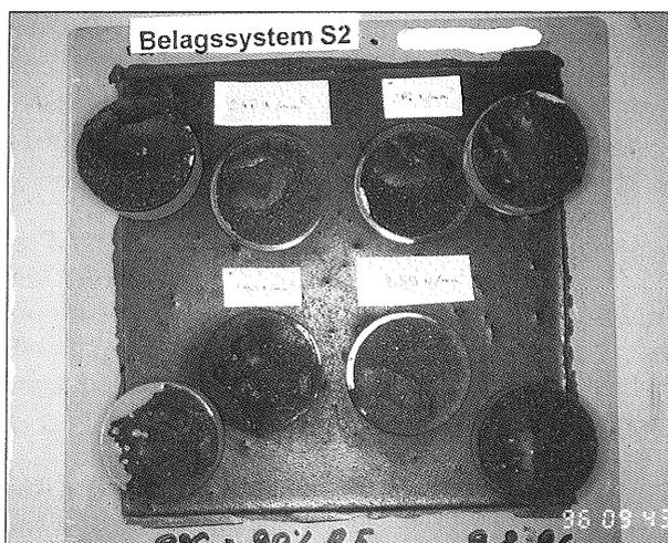
**Bild 1:** Probekörper Belagssystem S2 bei  $8 \text{ °C}$  und  $90 \%$  rel. Luftfeuchte
