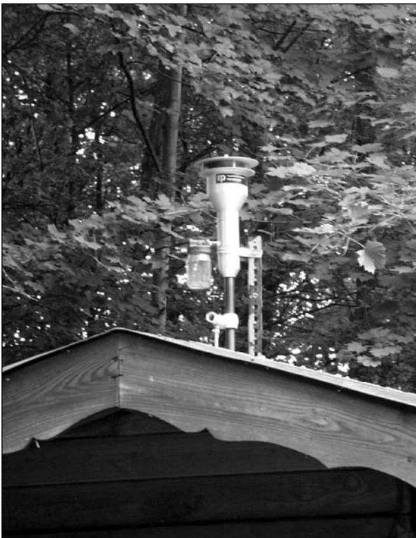
Bild 3.2: PM 10 -Messkopf auf einer der Messstationen
