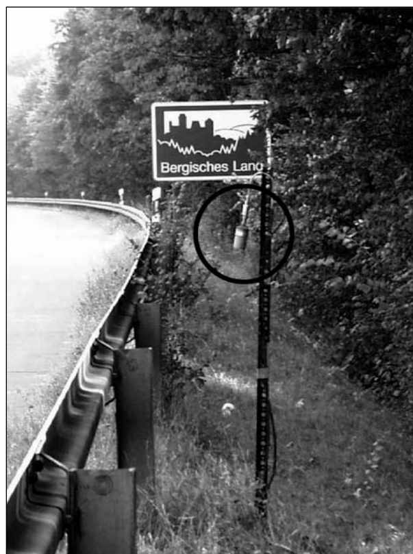
Bild 3.1: Ansaugkopf für die gasförmigen Luftschadstoffe
