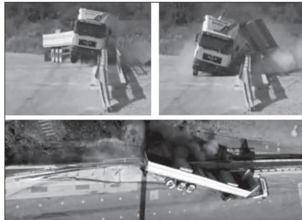
**Bild 46:** Fotodokumentation Anprallprüfung FRS-System Stahl-3 (H4b, TB 81), Quelle: FRS-Prüfungen
