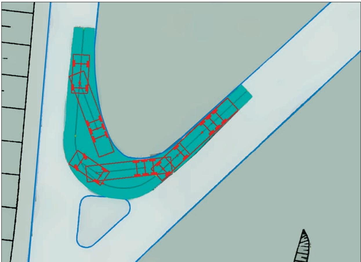
**Bild 80:** Schleppkurve Sattelzug Einmündung 3
