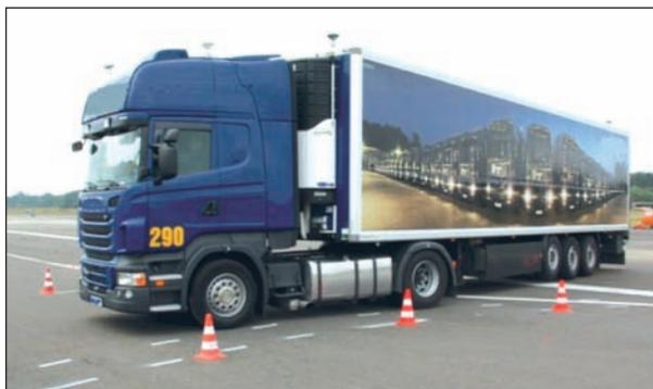
**Bild 56:** Verwindung des Fahrzeugs bei Einfahrt in den Kreisverkehr
