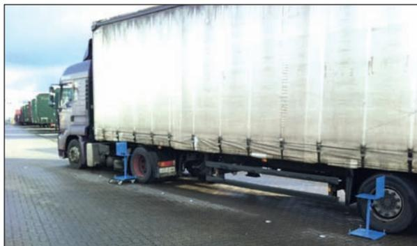
**Bild 27:** Messaufbau zur lasergestützten Fahrzeugvermessung
