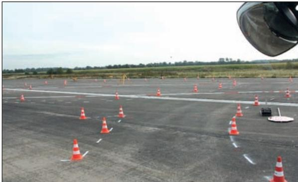
**Bild 37:** Markierungen mit Sprühkreide und Leitkegeln
