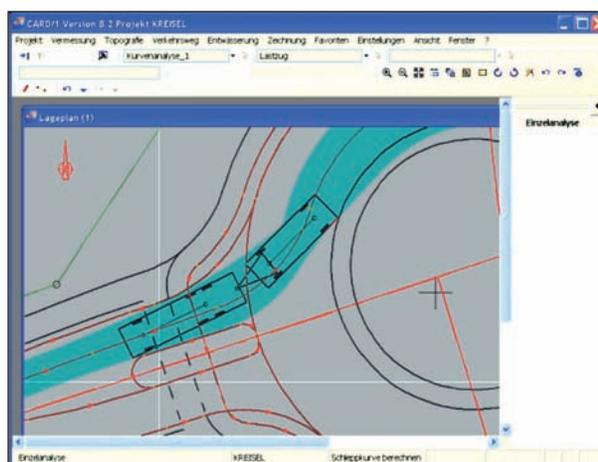
**Bild 45:** Darstellung einer Hüllkurve (Quelle: CARD/1 Software)
