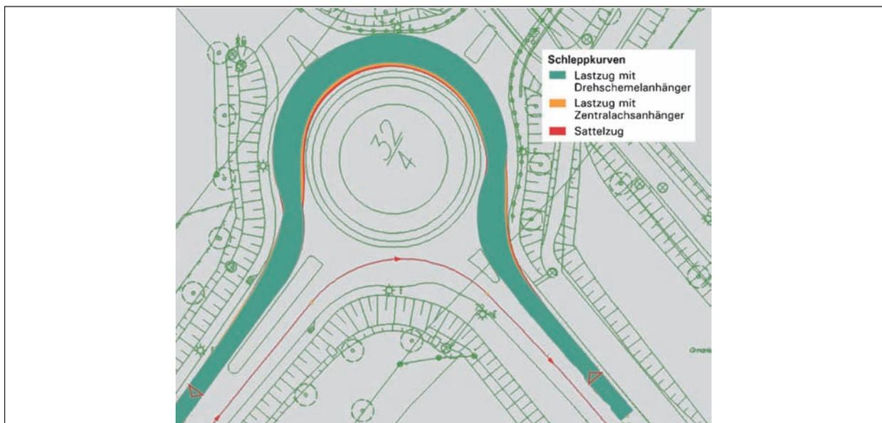
Bild 75: Vergleich der Schleppkurven unterschiedlicher Fahrzeugtypen (CARD/1)
