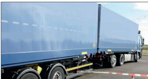
**Bild 66:** Verwindung der Fahrzeugkombination Lastzug mit Zentralachsanhänger
