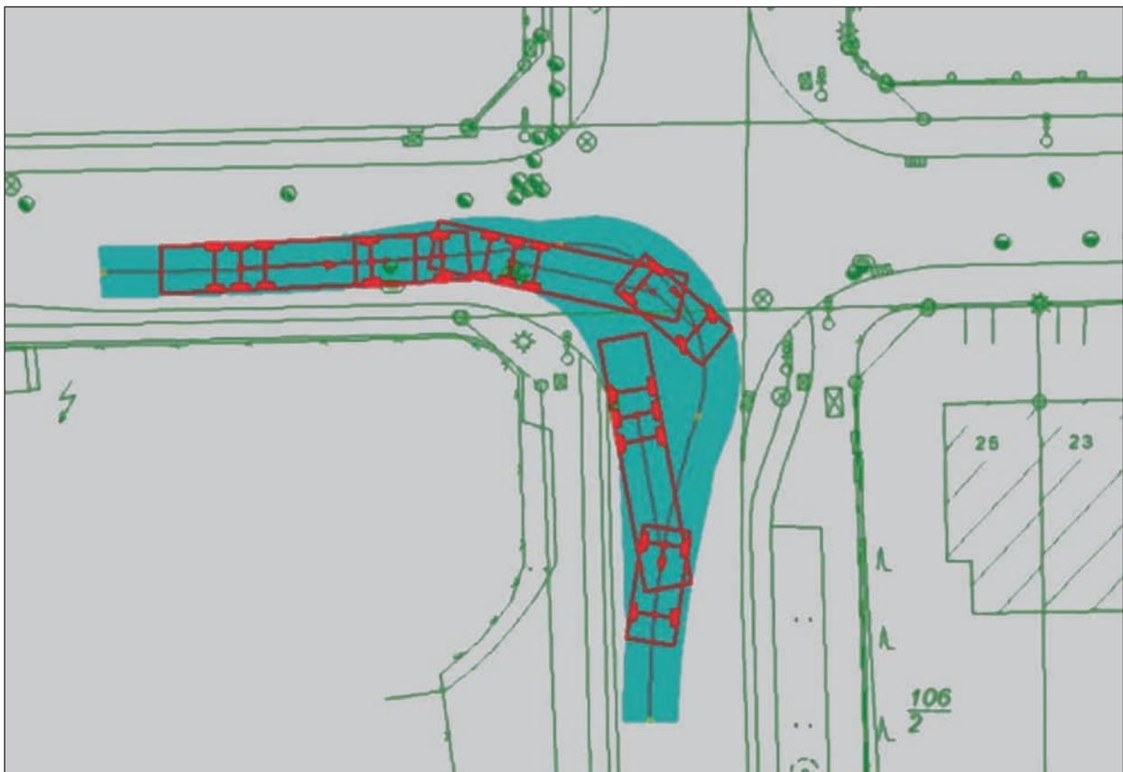
**Bild 88:** Schleppkurve Sattelzug in Kreuzung 4
