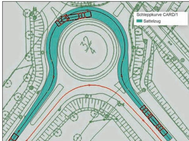
Bild 51: Schleppkurve in CARD/1
