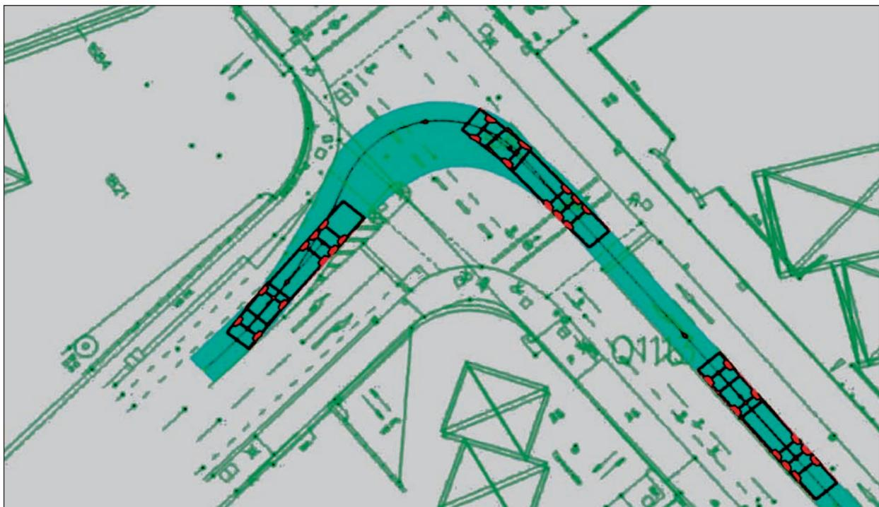
Bild 78: Schleppkurve Sattelzug Einmündung 1
