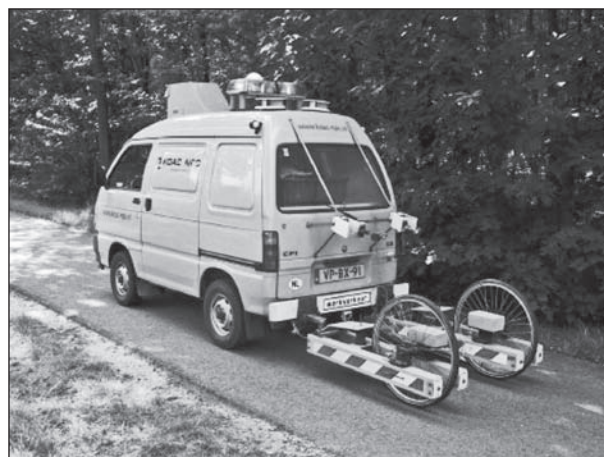
Bild 5-11: Fietscomfortmeter (FCM) von KOAC-NPC (NL)
