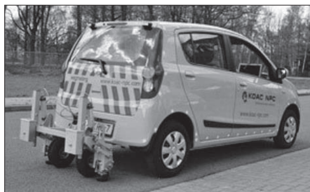
Bild 5-12: Neuer Fietscomfortmeter (FCM) von KOAC-NPC (NL)
