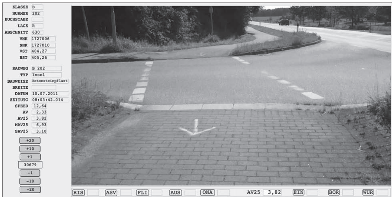
Bild 7-17: Beispiel für Typ „Insel“ der Bauweise Betonsteinpflaster
