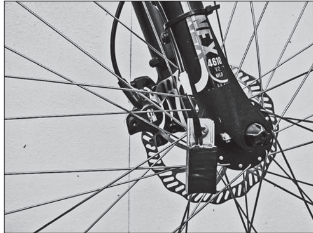
Bild 7-3: Beschleunigungssensor in der Nähe der Vorderachse des Messfahrrads
