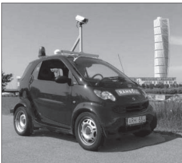
Bild 5-10: Erfassungssystem für Radwege der Firma Ramböll RST (SE)
