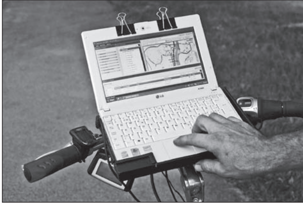
Bild 5-2: Notebook zur Registrierung von Radwegschäden [NCC 2009]
