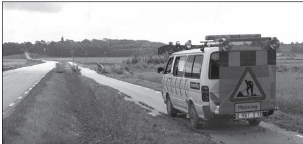
Bild 5-4: Videoerfassungssystem der Firma Ramböll RST (SE)
