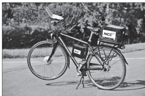
Bild 5-1: Inspektionsfahrrad von NCC Roads [NCC 2009]
