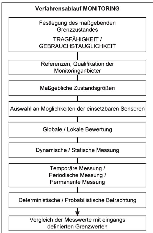
Bild 4: Ablaufdiagramm Bauwerksmonitoring nach [55]
