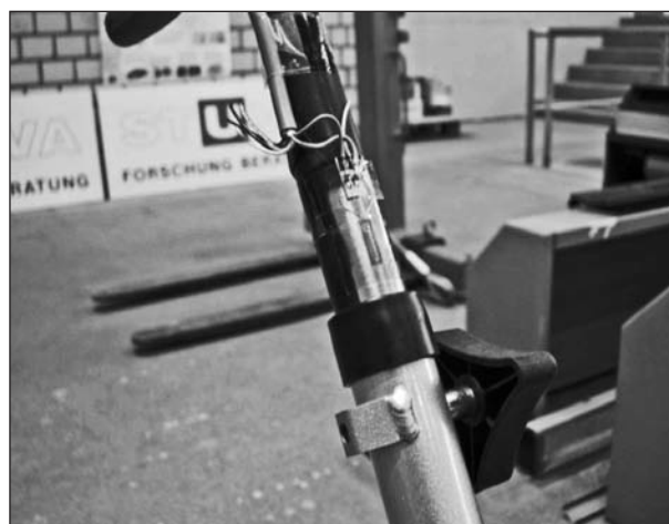
Bild 69: Dehnungsmessstreifen am Griff des Rollators (Detail)
