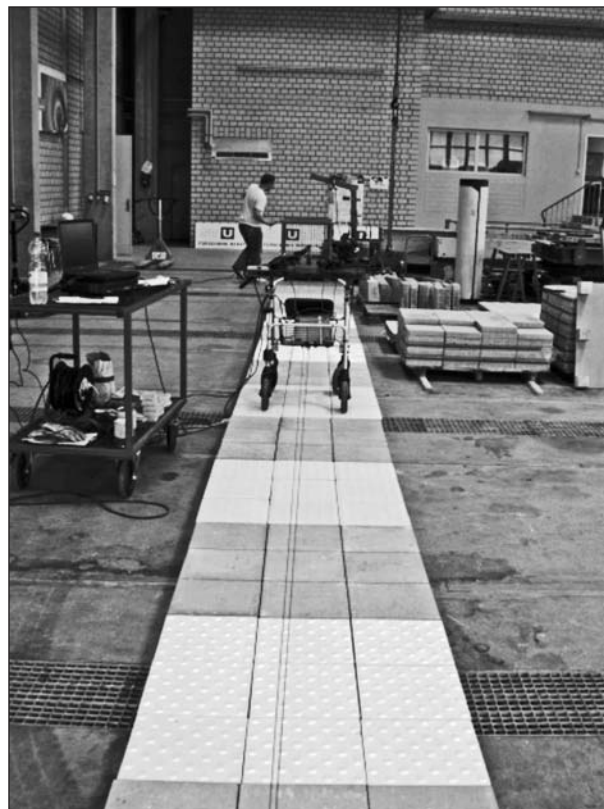
Bild 68: Teststrecke mit wechselnden Oberflächenstrukturen für Erschütterungsmessungen am Rollator
