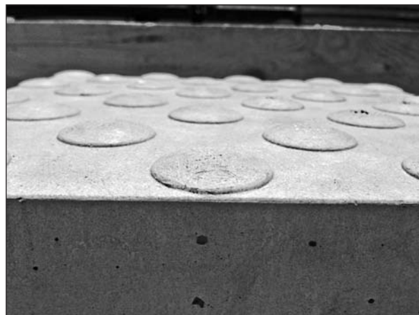
Bild 98: Im Test verwendete Kegelstümpfe mit großem Durchmesser (Foto: Boenke)
