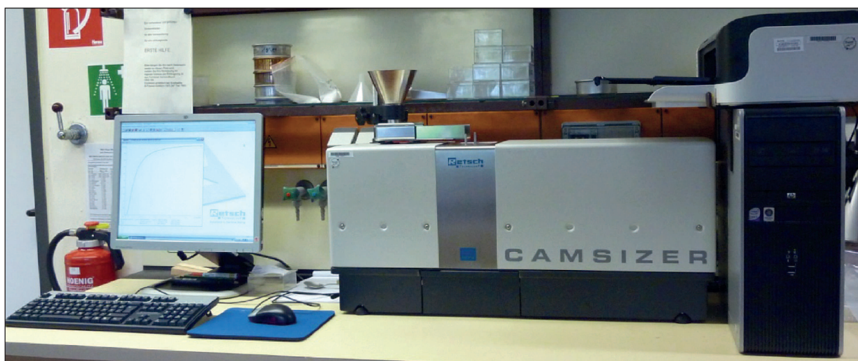
Bild 5: Bildschirm, optisches Partikelmessgerät „Camsizer®“, PC, und Drucker
