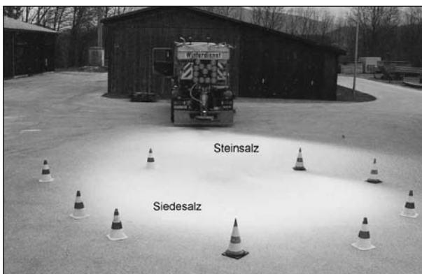
Bild 18: Vergleich der Streubilder bei der Austragung von Siede- und Steinsalz
