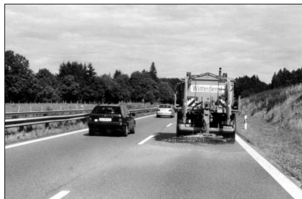
Bild 7: Ausbringen von Steinsalz mit Anfeuchtung (FS30-Verfahren, 30 g/m 2 Streudichte, 6 m Streubreite, 50 km/h Fahrgeschwindigkeit)
