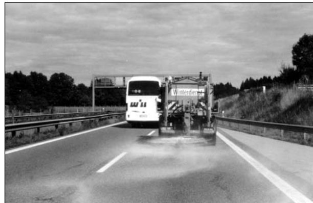
Bild 6: Ausbringen von Steinsalz ohne Anfeuchtung (30g/m 2 Streudichte, 6 m Streubreite, 50 km/h Fahrgeschwindigkeit)
