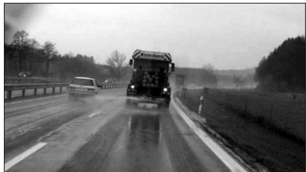
Bild 26: Ausbringung von Siedesalz mit Streumaschine Typ STA 95 der Firma Küpper-Weisser ohne Anfeuchtung bei 60 km/h, 7 m Streubreite und 20 g/m 2 Streudichte
