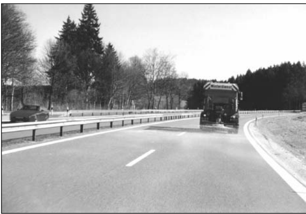
Bild 38: Streubild vor dem Messfeld für die quantitative Bewertung von Verwehversuchen
