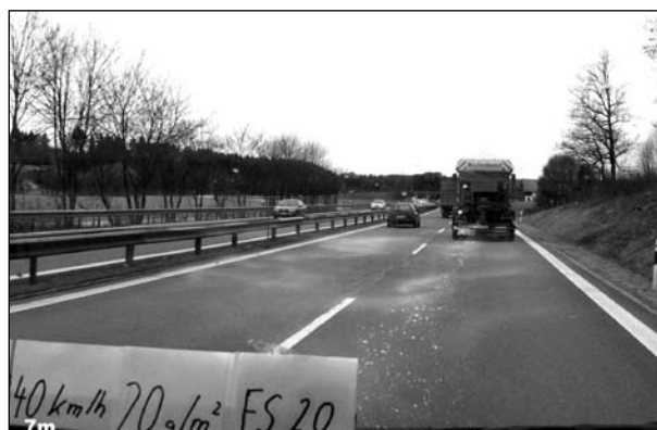
Bild 23: Ausbringung von Siedesalz mit Streumaschine Typ STA 95 der Firma Küpper-Weisser mit Anfeuchtungsgrad 20 bei 40 km/h, 7 m Streubreite und 20 \text{ g/m}^2 Streudichte
