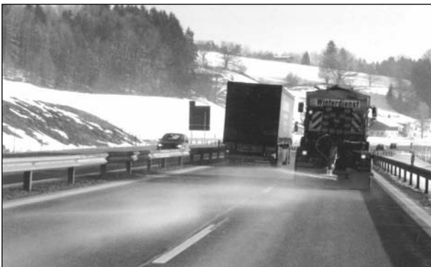
Bild 17: Tausalzausbringung des Streuertyps 6002 der Firma Beilhack (5 g/m 2 , ca. 50 km/h, ohne Anfeuchtung)
