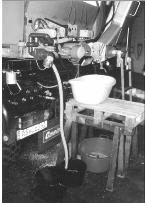
Bild 10: Auffangen der Tausalze und Lösungen bei der Überprüfung der Streudichte
