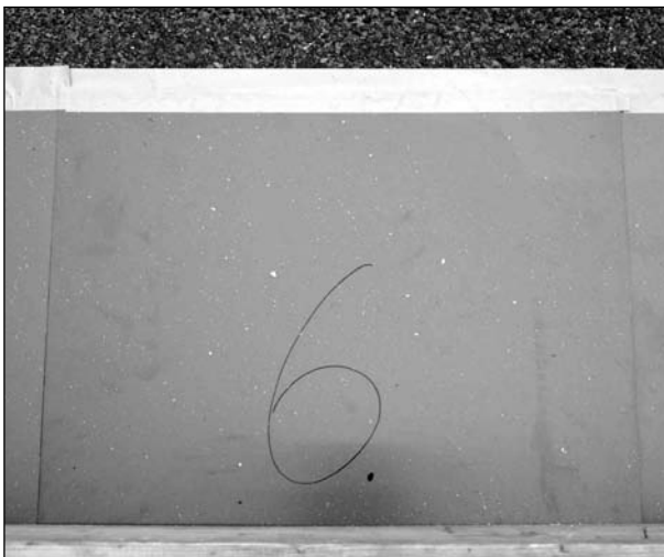
Bild 39: Auffangplatte mit verwehtem Tausalz
