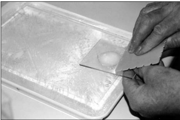
Bild 3: Auftragen von Feuchtsalz auf eine Eisplatte
