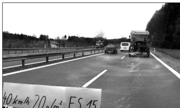
Bild 22: Ausbringung von Siedesalz mit Streumaschine Typ STA 95 der Firma Küpper-Weisser mit Anfeuchtungsgrad 15 bei 40 km/h, 7 m Streubreite und 20 \text{ g/m}^2 Streudichte
