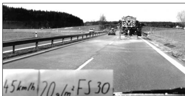
Bild 34: Ausbringung von Siedesalz mit Streumaschine Typ 6002 der Firma Beilhack mit Anfeuchtungsgrad 30 bei 45 km/h, 7 m Streubreite und 20 g/m 2 Streudichte
