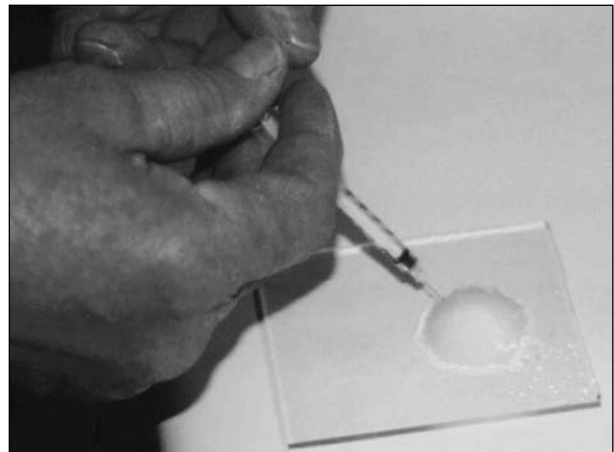
Bild 2: Anfeuchten von trockenem Natriumchlorid mit einer Chloridlösung
