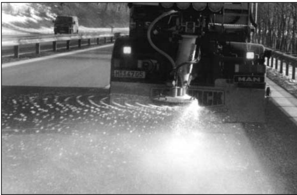
Bild 16: Tausalzausbringung des Streuertyps 6002 der Firma Beilhack (FS30-Streuung)
