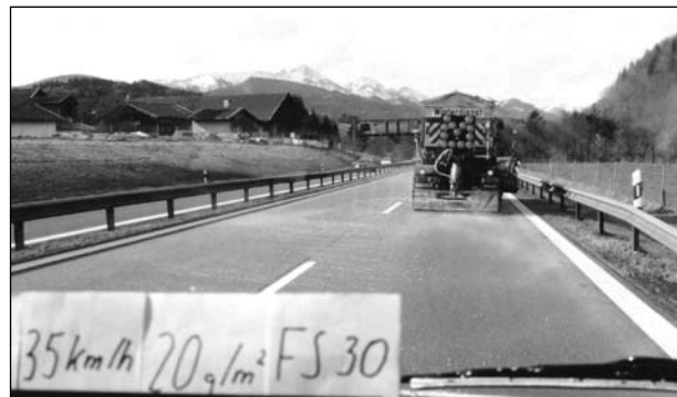
Bild 35: Ausbringung von Siedesalz mit Streumaschine Typ 6002 der Firma Beilhack mit Anfeuchtungsgrad 30 bei 35 km/h, 7 m Streubreite und 20 g/m 2 Streudichte
