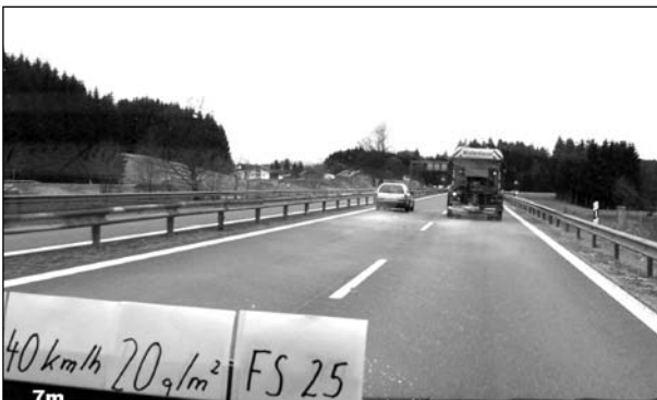
Bild 24: Ausbringung von Siedesalz mit Streumaschine Typ STA 95 der Firma Küpper-Weisser mit Anfeuchtungsgrad 25 bei 40 km/h, 7 m Streubreite und 20 g/m 2 Streudichte
