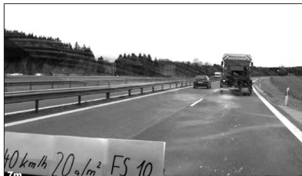
Bild 21: Ausbringung von Siedesalz mit Streumaschine Typ STA 95 der Firma Küpper-Weisser mit Anfeuchtungsgrad 10 bei 40 km/h, 7 m Streubreite und 20 \text{ g/m}^2 Streudichte
