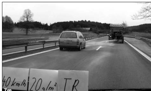
Bild 19: Ausbringung von Siedesalz mit Streumaschine Typ STA 95 der Firma Küpper-Weisser ohne Anfeuchtung bei 40 km/h, 7 m Streubreite und 20 \text{ g/m}^2 Streudichte
