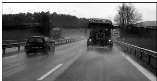
Bild 27: Ausbringung von Siedesalz mit Streumaschine Typ STA 95 der Firma Küpper-Weisser mit Anfeuchtungsgrad 30 bei 60 km/h, 7 m Streubreite und 20 g/m 2 Streudichte
