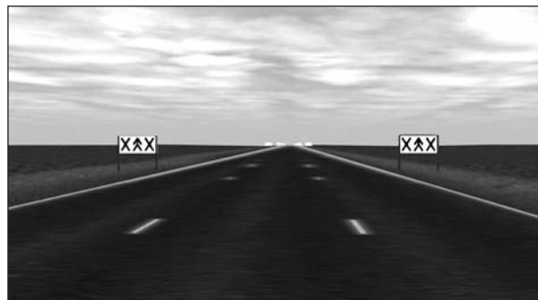
Bild 2: Lane-Change-Task-Anordnung in der Fahrsimulation (Lehrstuhl für Ergonomie – TU München)
