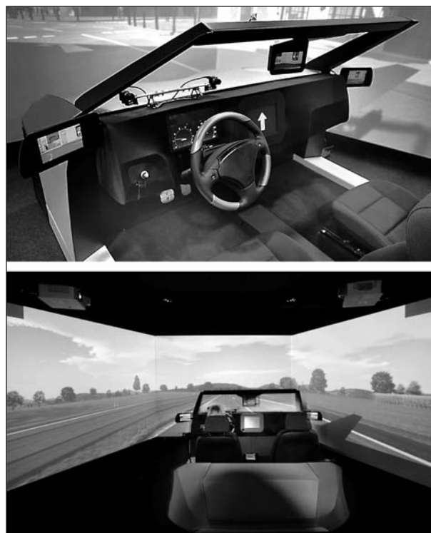
Bild 6: Der Fahrsimulator der BAST – Fahrzeug-Mockup und Darstellung der Strecke über drei Leinwände. (Foto: Hardy Holte)
