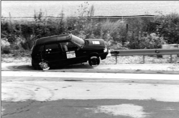
**Bild 88:** Anprallvorgang – seitlich zum System
