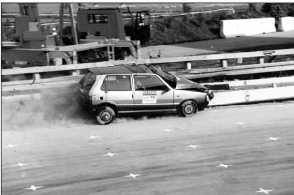
**Bild 35:** Anprallvorgang – Ansicht seitlich zum System
