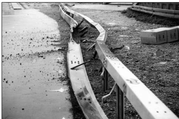
**Bild 53:** System nach der Prüfung: Schäden und Anprallspuren (Ansicht entgegen der Anprallrichtung)
