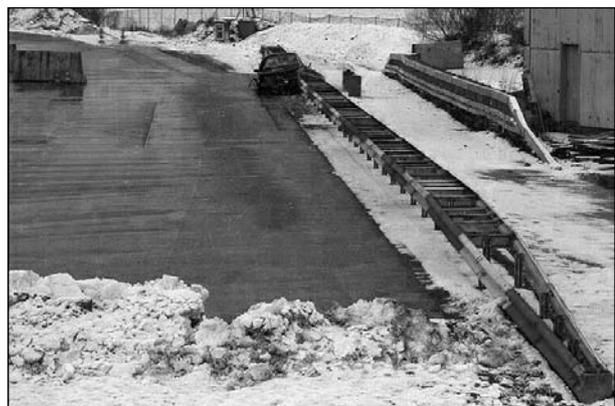
Bild 17: Anprallvorgang – Ansicht entgegen der Anfahrriichtung
