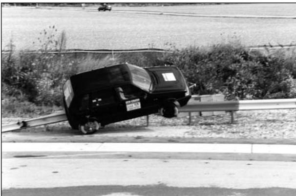
**Bild 89:** Anprallvorgang – seitlich zum System
