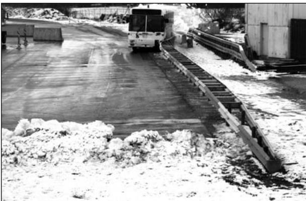
**Bild 24:** Anprallvorgang – Ansicht entgegen der Anfahrriichtung
