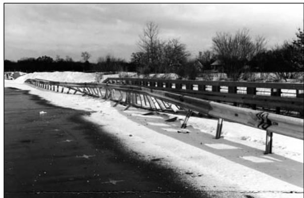
**Bild 27:** System nach der Prüfung (Ansicht entgegen der Anprallrichtung)
