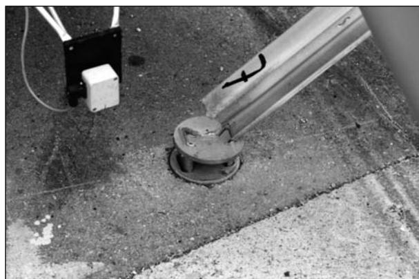
**Bild 11:** Beispiel: Pfosten Nr. 7 nach Anprall mit halber Sollge- schwindigkeit
