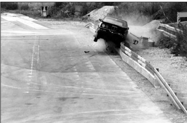
**Bild 80:** Anprallvorgang – Ansicht entgegen der Anfahrrichtung
