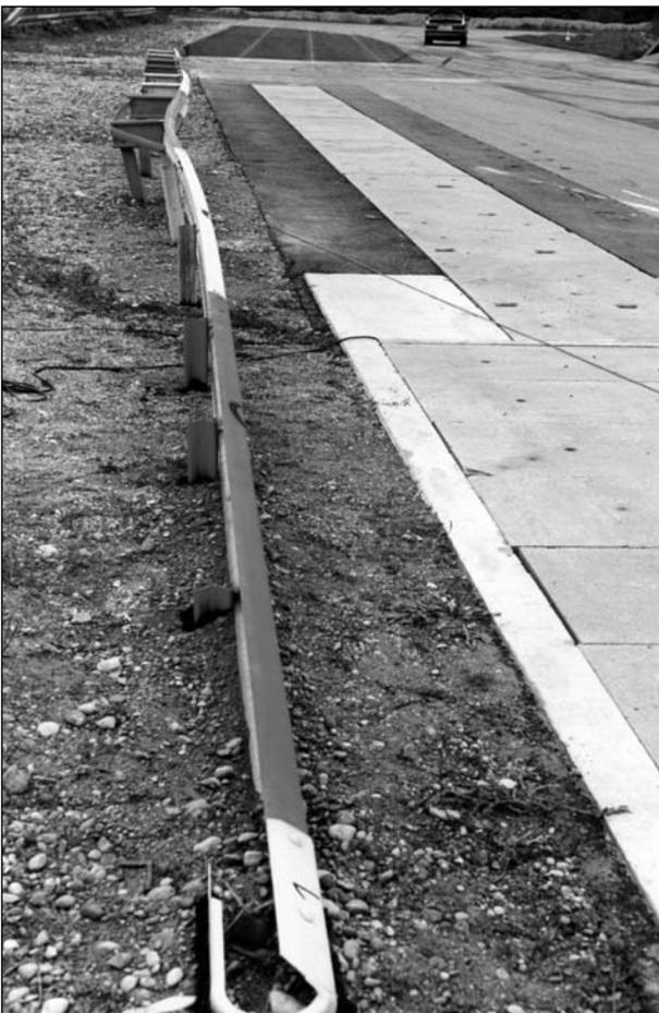
**Bild 100:** System nach der Prüfung; Endstellung des Testfahrzeugs
