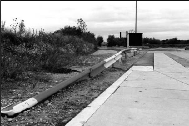
**Bild 99:** System nach der Prüfung; Endstellung des Testfahrzeugs
