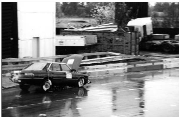
**Bild 49:** Anprallvorgang – Ansicht seitlich zum System
