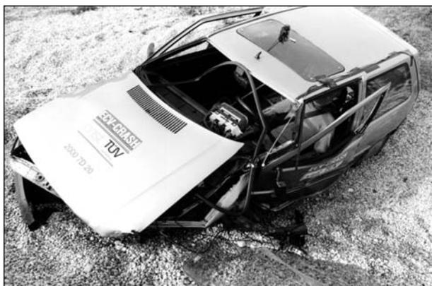
**Bild 41:** Schäden am Testfahrzeug
