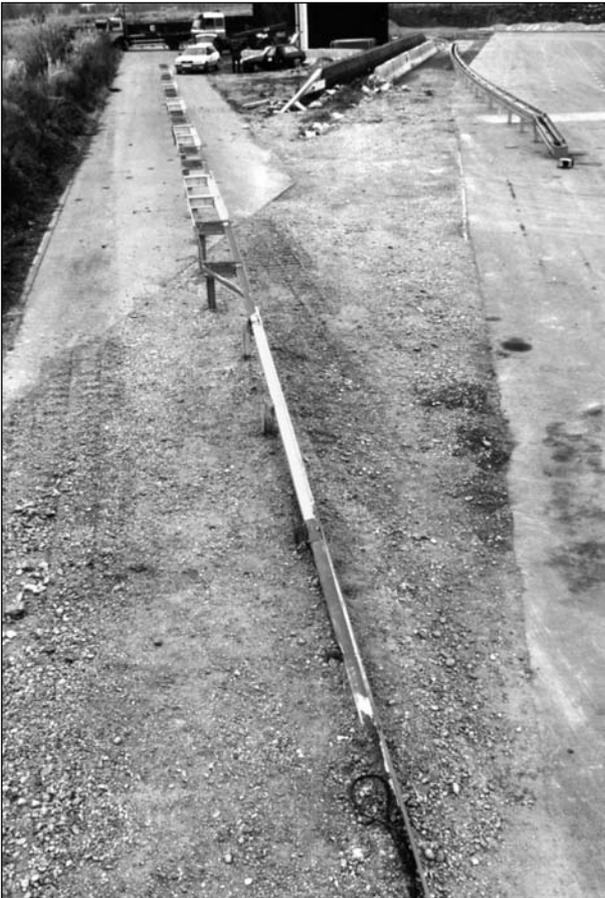
**Bild 111:** Situation nach der Prüfung mit Endstellung des Testfahrzeugs nach dem Sekundärprall
