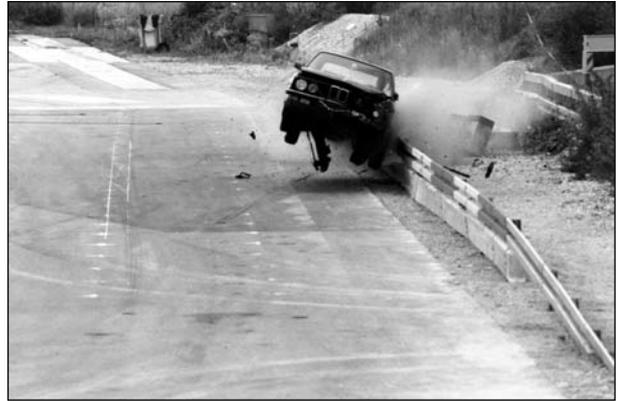
**Bild 81:** Anprallvorgang – Ansicht entgegen der Anfahrrichtung
