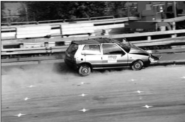
**Bild 34:** Anprallvorgang – Ansicht seitlich zum System
