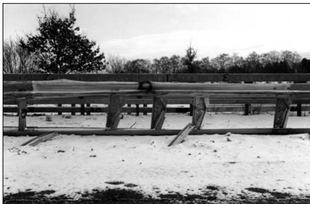
**Bild 28:** System nach der Prüfung (Ansicht entgegen der Anprallrichtung)
