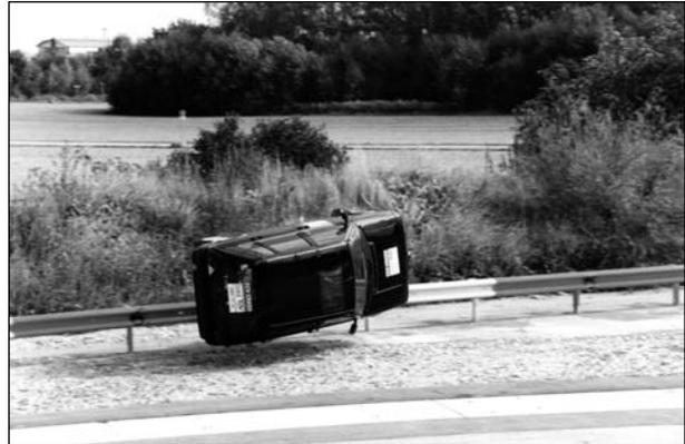
**Bild 91:** Anprallvorgang – seitlich zum System
