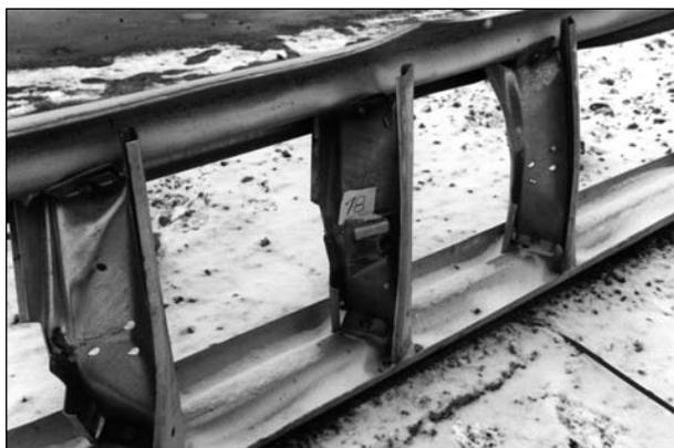
**Bild 29:** System nach der Prüfung (Ansicht entgegen der Anprallrichtung)
