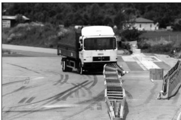
**Bild 8:** Missglückter Anprall; Endstellung des Testfahrzeugs
