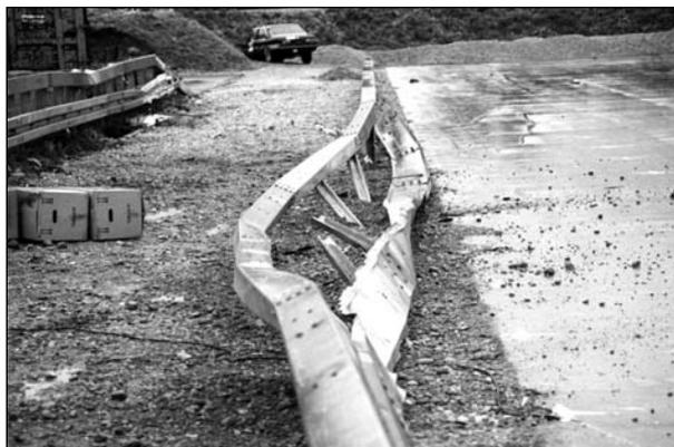
**Bild 52:** System nach der Prüfung (Schäden und Anprallspuren); Endstellung des Testfahrzeugs
