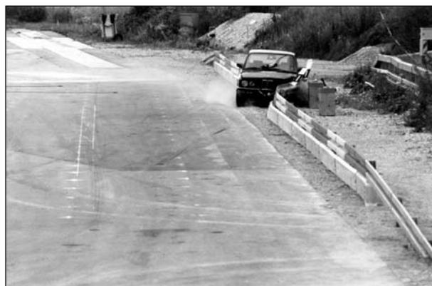
**Bild 77:** Anprallvorgang – Ansicht entgegen der Anfahrriichtung
