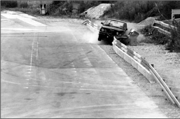
**Bild 78:** Anprallvorgang – Ansicht entgegen der Anfahrrichtung
