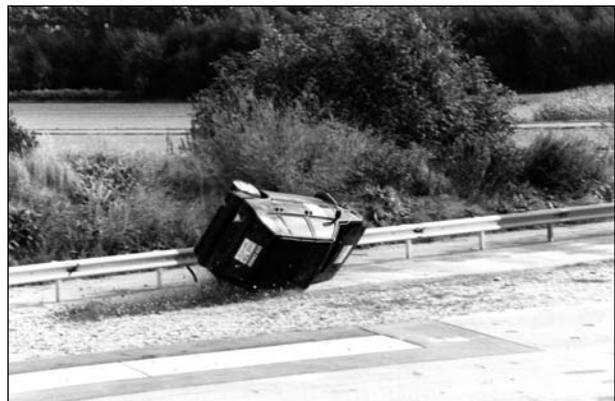
**Bild 92:** Anprallvorgang – seitlich zum System
