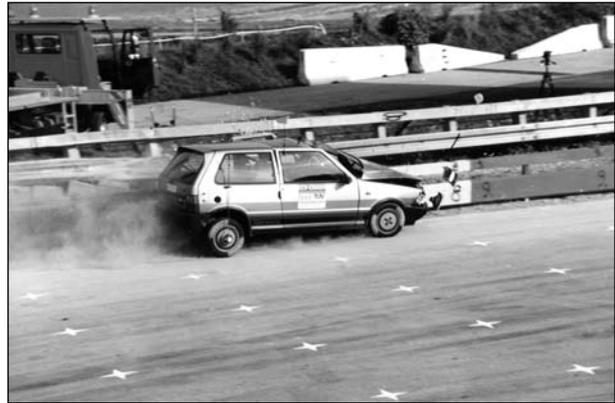
**Bild 36:** Anprallvorgang – Ansicht seitlich zum System
