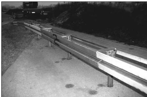
**Bild 109:** Situation nach der Prüfung – Blick gegen die Anfahr-richtung
