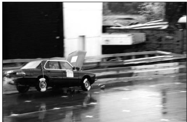
**Bild 48:** Anprallvorgang – Ansicht seitlich zum System
