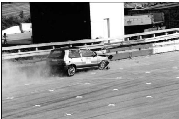
**Bild 39:** Anprallvorgang – Ansicht seitlich zum System
