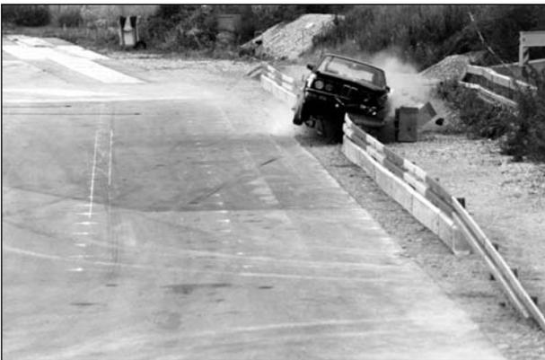
**Bild 79:** Anprallvorgang – Ansicht entgegen der Anfahrrichtung
