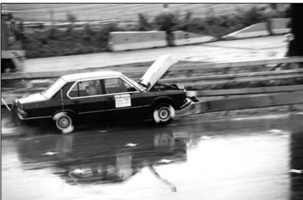
**Bild 45:** Anprallvorgang – Ansicht seitlich zum System
