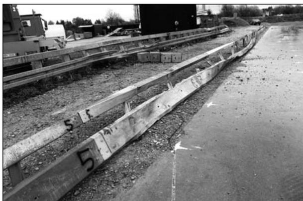
**Bild 51:** System nach der Prüfung (Schäden und Anprallspuren); Endstellung des Testfahrzeugs
