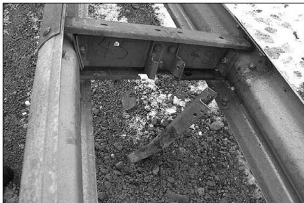
**Bild 21:** Beispielhafte Darstellung eines – wie vorgesehen – aus der Halteklau abgesicherten Pfostens
