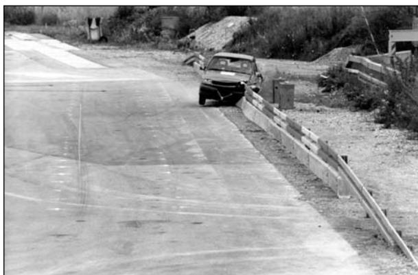
**Bild 62:** Anprallvorgang – Ansicht entgegen der Anfahrrichtung
