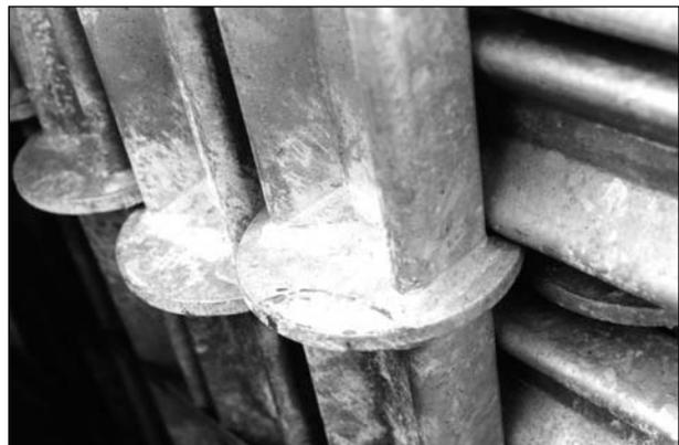
**Bild 5:** Modifizierter Steckpfosten SIGMA mit ringsum kraftschlüssig angeschweißter Ronde
