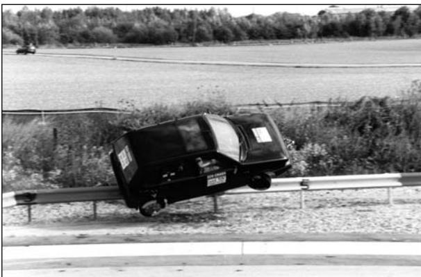
**Bild 90:** Anprallvorgang – seitlich zum System
