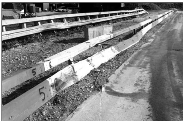
**Bild 40:** System nach der Prüfung (Schäden und Anprallspuren)
