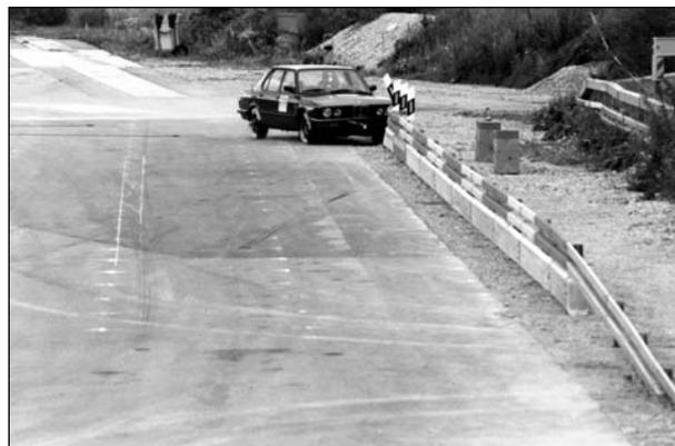
**Bild 75:** Anprallvorgang – Ansicht entgegen der Anfahrriichtung
