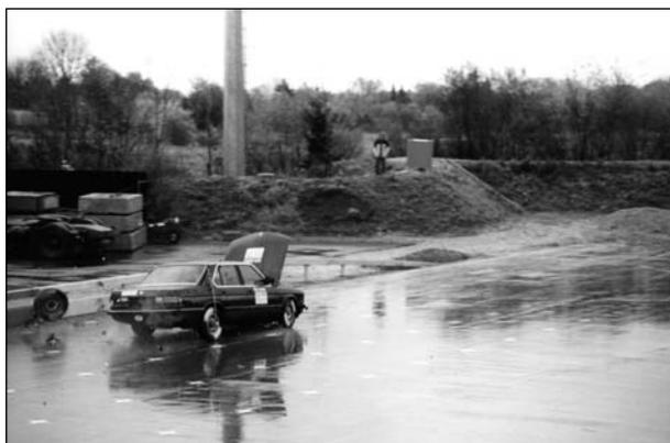
**Bild 50:** Anprallvorgang – Ansicht seitlich zum System
