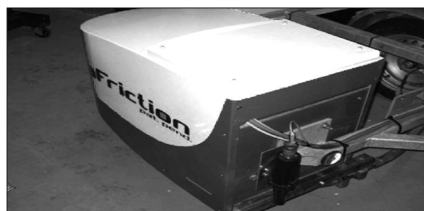
Bild 11: Messeinheit des ViaFriction [eigene Darstellung]
