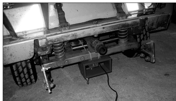
Bild 16: Position der USB-Kamera am GripTester (1)
