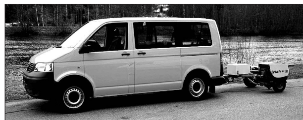
Bild 10: Messeinheit des ViaFriction [eigene Darstellung]
