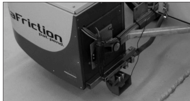
Bild 15: Position der USB-Kamera am ViaFriction
