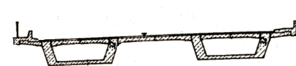
Bild 32: Doppelhohlkastenquerschnitt der Beispielbrücke (Bauwerksbuch)
