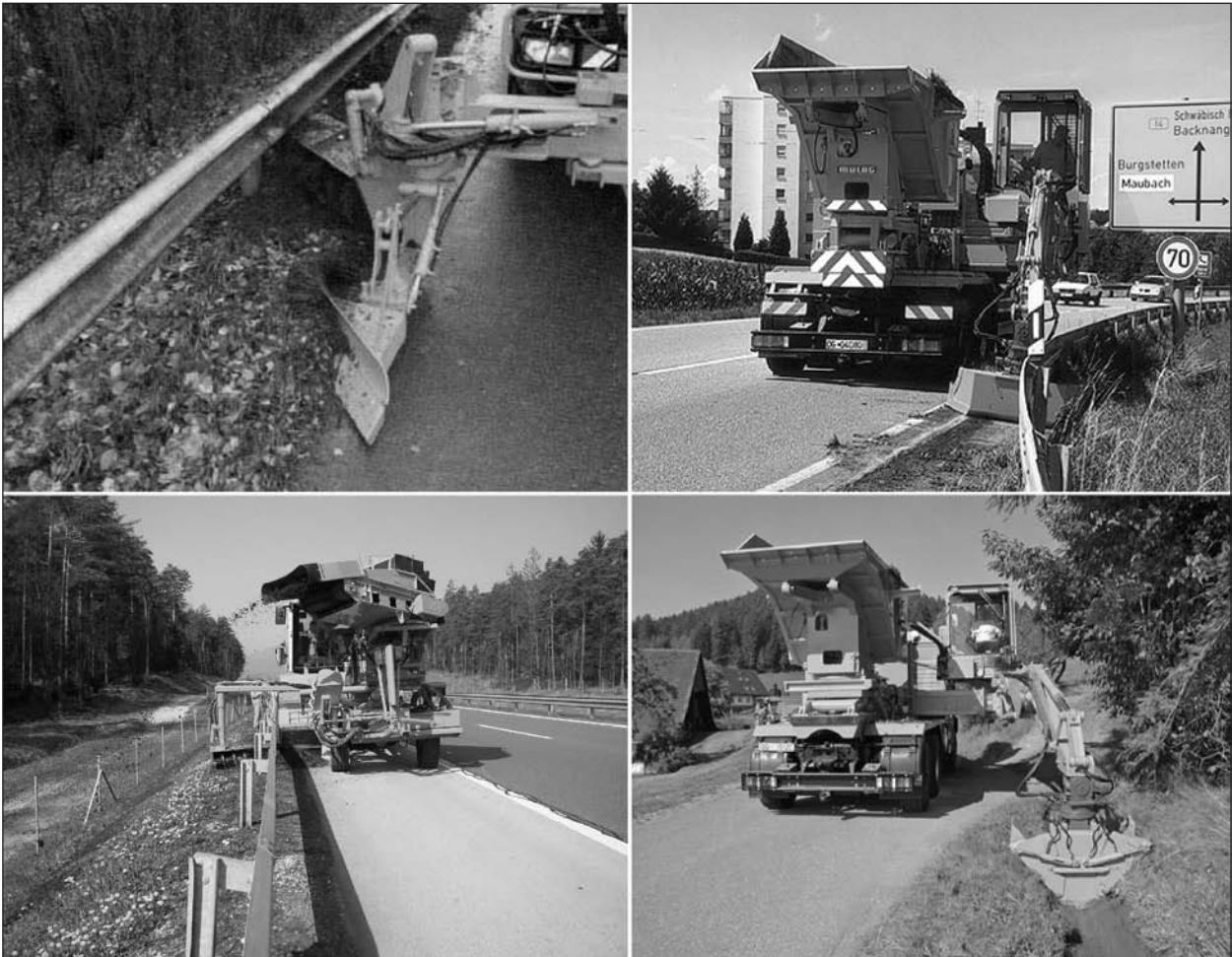
Bild 2: Wie wird Bankett geschält? Beispiele von oben links nach unten rechts: a) Schälern mit seitlichem Verschieben, b) Fräsen mit Aufnehmen, c) Fräsen mit Verblasen, d) Grabenräumen mit Aufnehmen
