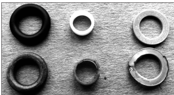
Bild 149: Dichtungssatz Hochdruckinjektor, Vergleich Neu- und Altteile
