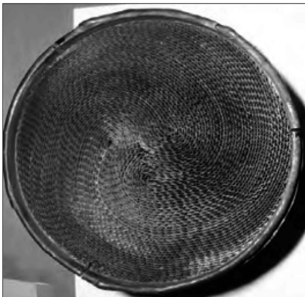
Bild 44: Katalysator betrieben mit Dieseldieselkraftstoff nach 200.000 km aus [70]
