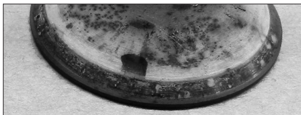
Bild 156: Detailansicht Auslassventil, VW Golf
