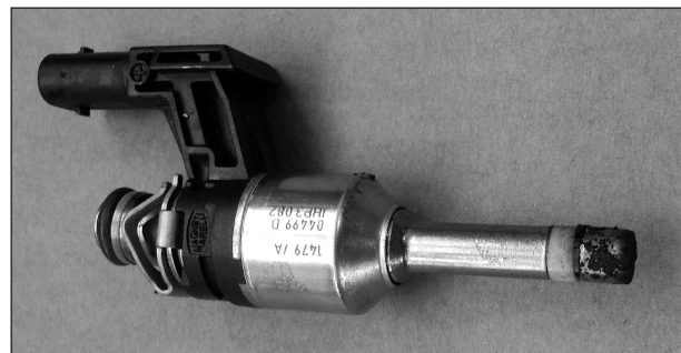
Bild 147: Hochdruckinjektor, VW Golf
