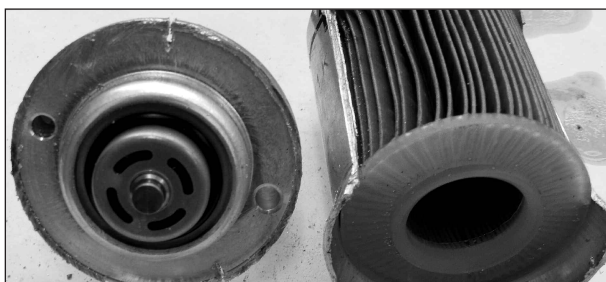
Bild 150: Kraftstofffilter, VW Golf
