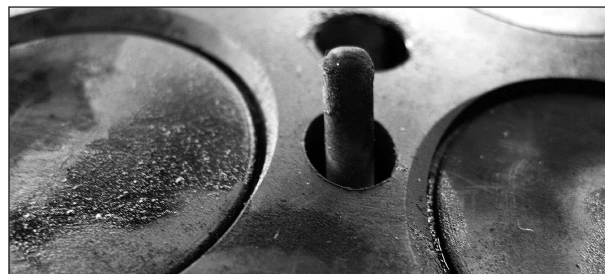
Bild 122: Glühkerze und Ventile
