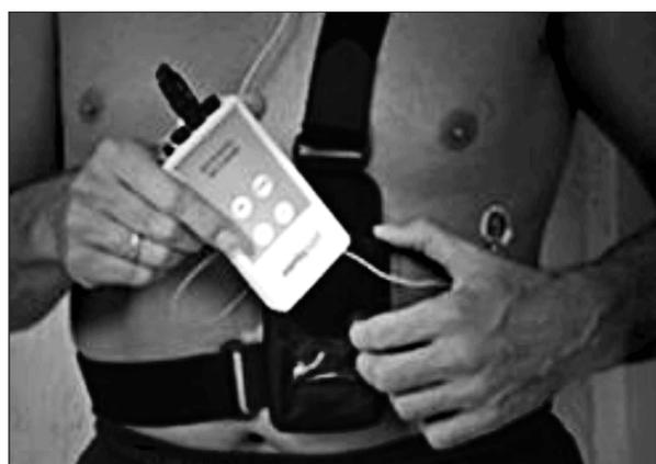
Bild 35: Tragbares Aufzeichnungsgerät für physiologische Daten (Varioport, Fa. Becker – Meditec); Quelle: <http://www.fit-fuer-usability.de/archiv/biometrie-mit-varioport/>
