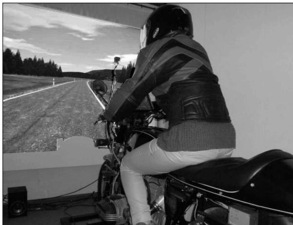
Bild 29: Darstellung des Wankwinkels über entsprechende Kameradrehung
