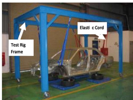
Bild 37: Versuchsaufbau zur Schwingungsanalyse [SRNK11]
