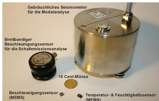
Bild 46: Größenvergleich zwischen herkömmlichen Beschleunigungsmessern und MEMS-Sensoren [KRGR10]
