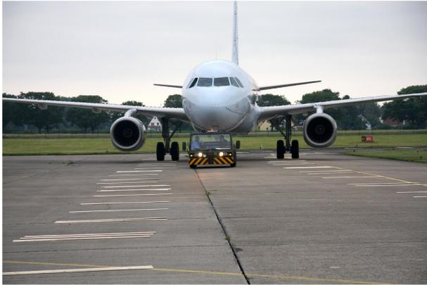
Bild 41: Demonstrator „ATRA“ des DLR bei Rollversuchen auf dem Taxiway [RICH09]
