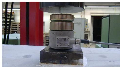
Bild 9: Kraftmessdose auf Lasteinleitungsplatte
