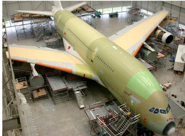
Bild 40: Aufbau eines Standschwingversuchs des Airbus A380 [RICH09]
