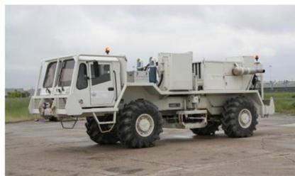
Bild 25: VibroScan-Generator [STE112]
