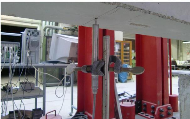
Bild 6: Induktiver Wegaufnehmer zur Messung der Durchbiegung eines Stahlbetonbalkens
