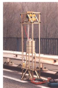
Bild 24: links: Unwuchterreger, im Vordergrund Impulshammer [CCMM06]; Mitte: Servohydraulischer Shaker [CANT04]; rechts: System zur stoßförmigen Anregung mit Fallgewichten [PEMD01]
