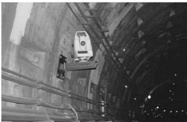
Bild 29 Tachymeter in einem Tunnel (die Prismen sind als helle Punkte zu erkennen) [BROW07]
