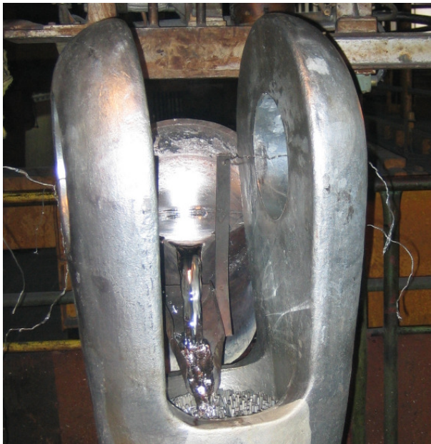
Bild 10: Verguss mit einer Metalllegierung [6]
