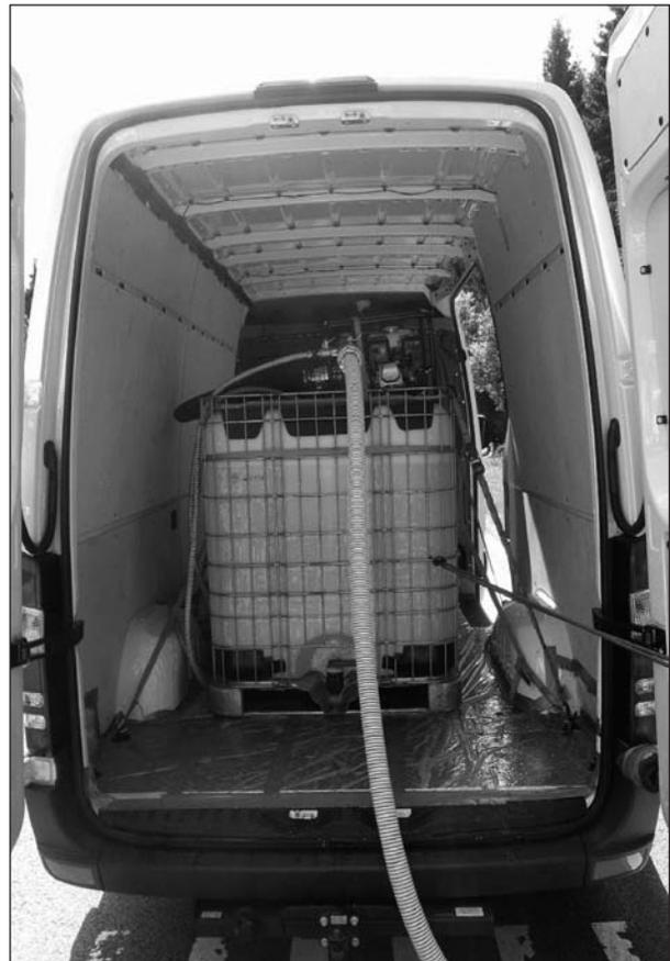
**Bild 50:** Wasserzuleitung vom Wassertank abgehend
