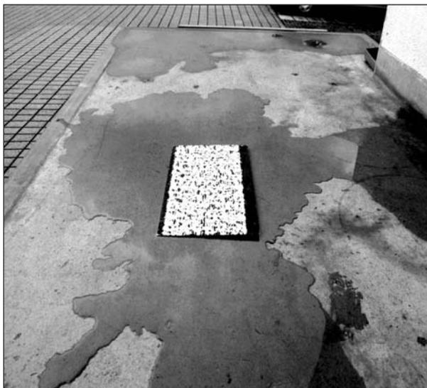
**Bild 15:** Strukturiertes Markierungsmuster zur Restwasserbestimmung
