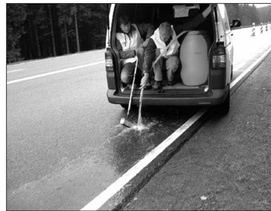
Bild 32: Spritzeinheit mit Quaste entsprechend Versuch 11
