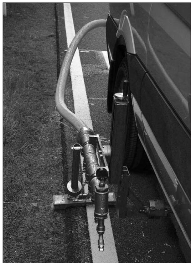
**Bild 51:** Schlauchsystem zur Düsenkonstruktion
