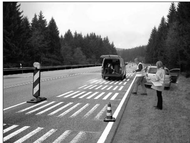
Bild 25: Statische Messung direkt nach dynamischer Bewässerung
