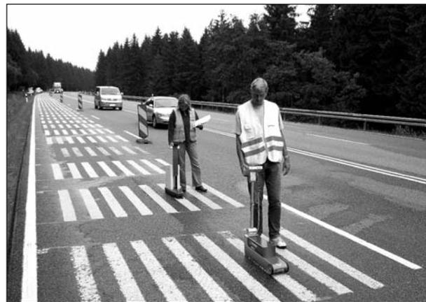
Bild 61: Statische Messungen nach dynamischer Bewässerung
