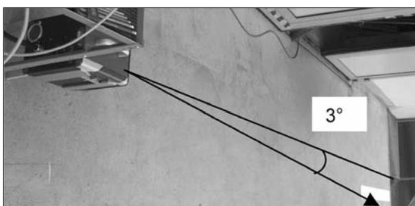
Bild 7: Auslenkung der Messoptik zum Standard auf 3°
