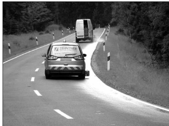
Bild 64: Bewässerungs- und Messfahrzeug im Einsatz von hinten
