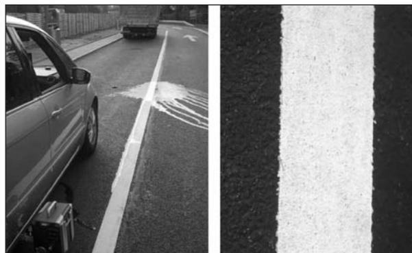
Bild 11: Messung einer Typ-I-Markierung
