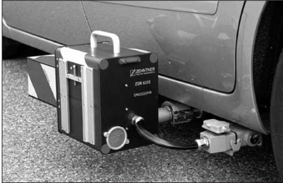
**Bild 66:** Messkopf des ZDR 6020 R<sub>L</sub>
