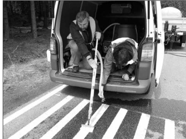
Bild 24: Handgeführte dynamische Bewässerung
