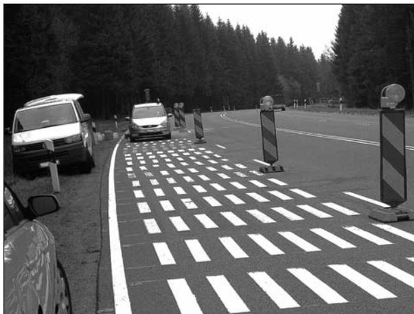
**Bild 46:** Dynamische Messungen mit ZDR 6020  $R_L$
