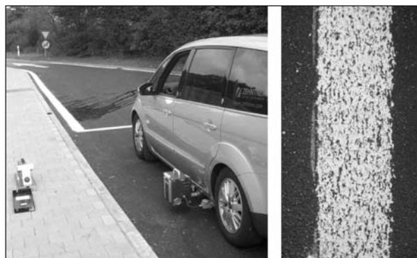
Bild 12: Messung einer Typ-II-Markierung
