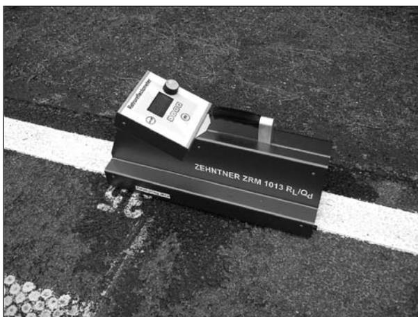
Bild 43: Statische Messung des Kaltplastik-Glattstrichs Typ II
