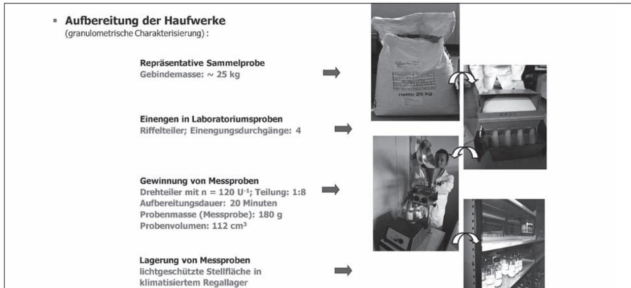
**Bild 12:** Ablaufschema zur Gewinnung repräsentativer Messproben aus einem handelsüblichen Liefergebilde
