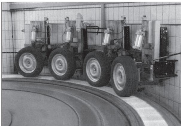
**Bild 3:** Rundlaufprüfanlage der BAST zur Systemprüfung von Markierungssystemen (Quelle: BAST)
