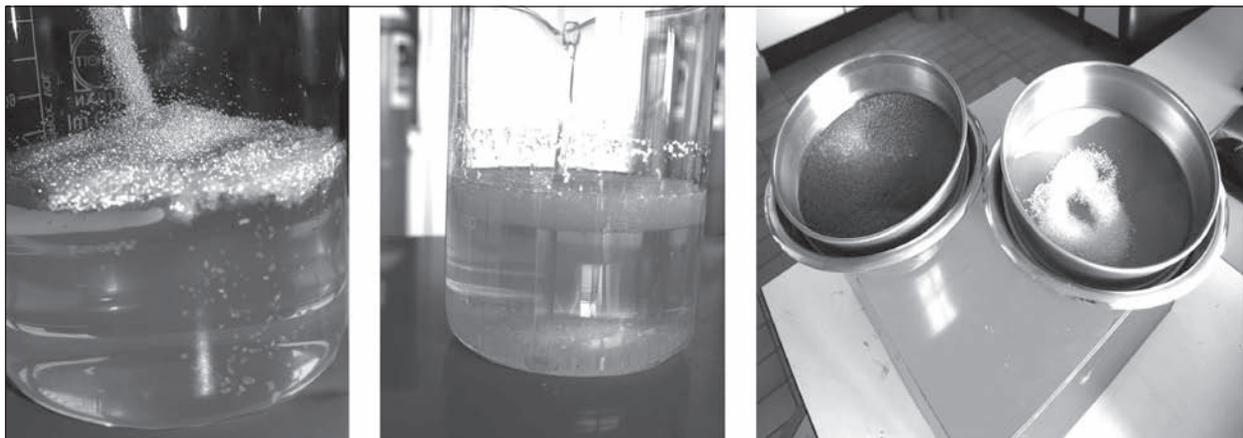
Bild 114: Phasenseparation durch Schwimm-/Sink-Verfahren
