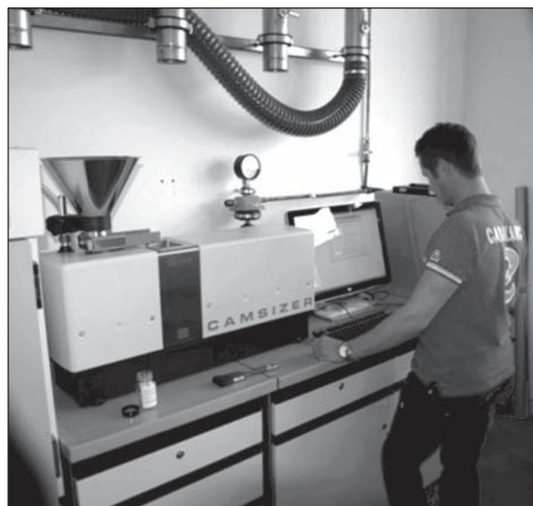
Bild 8: Camsizer®-Messstand im Mineralstoff-Labor der BAM
