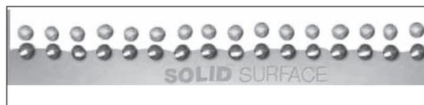
**Bild 143:** Schematische Darstellung der Ladungsverteilung auf einer Oberfläche (Quelle: [www.anton-paar.de](http://www.anton-paar.de))
