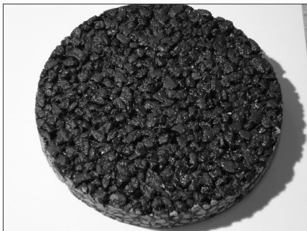
Bild 11: Oberfläche Bohrkern Kompakteinbau Profil 1
