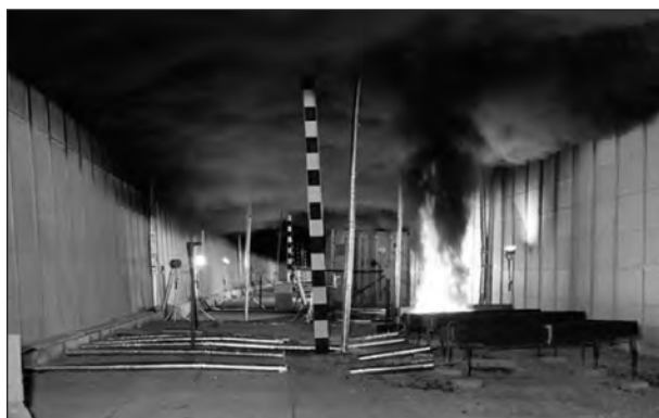
Bild 4-42: Durchführung eines Wannenbrandversuches [20]
