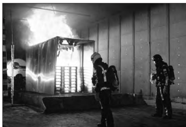
Bild 4-44: Brandversuch mit Alu-Frachtraum [20]
