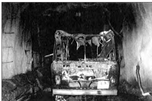
Bild 4-25: Reisebus nach dem Versuch [14]
