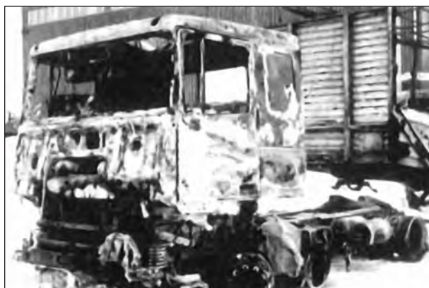
Bild 4-30: Zugmaschine nach Versuch HF1 [14]
