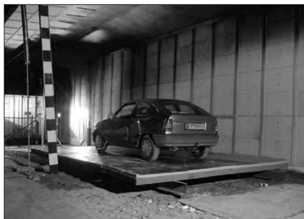
Bild 4-43: Aufstellung für Pkw-Brandversuch [20]
