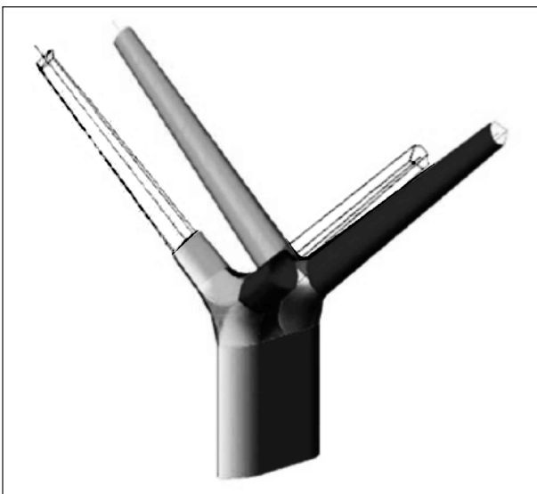
Bild 38: Simulation des Pfeilerkopfes mit Schrägstreben [73]
