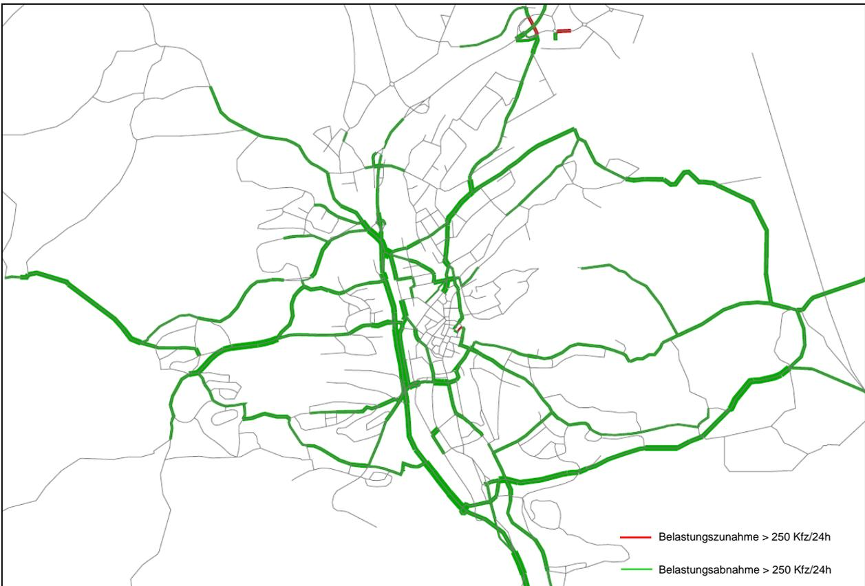
**Bild 48: Qualitatives Differenzbild des durchschnittlichen täglichen Kfz-Verkehrs für das Szenario „Pedelecsierung am Berg“ bezogen auf die Ausgangssituation; Beispielstadt Coburg**
