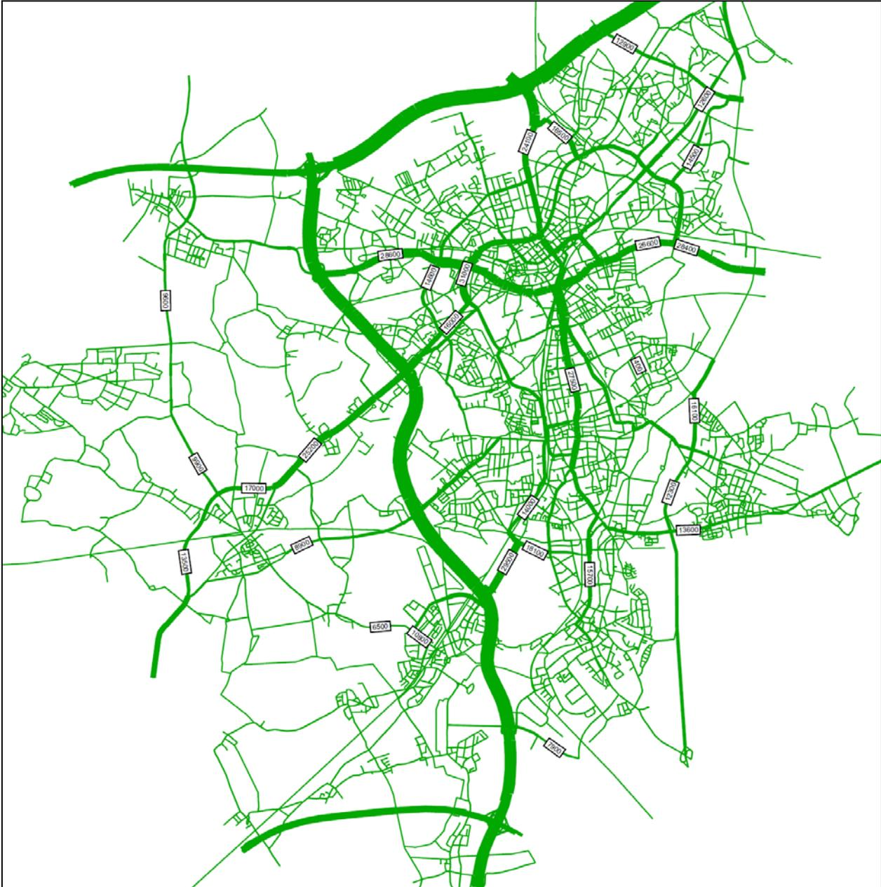
**Bild 62: Belastungsbild des durchschnittlichen täglichen Kfz-Verkehrs für das Zwischenszenario „bewusste Mobilität“; Beispielstadt Mönchengladbach**
