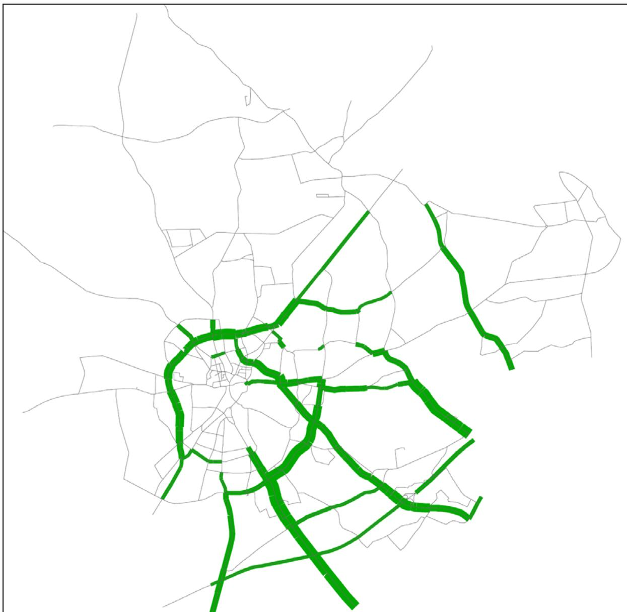
**Bild 41:** Qualitatives Differenzbild des durchschnittlichen täglichen Kfz-Verkehrs für das Szenario „Weiche und harte Maßnahmen“ bezogen auf die Ausgangssituation (Darstellung der Entlastungen > 1000 Kfz/24h); Beispielstadt Gütersloh
