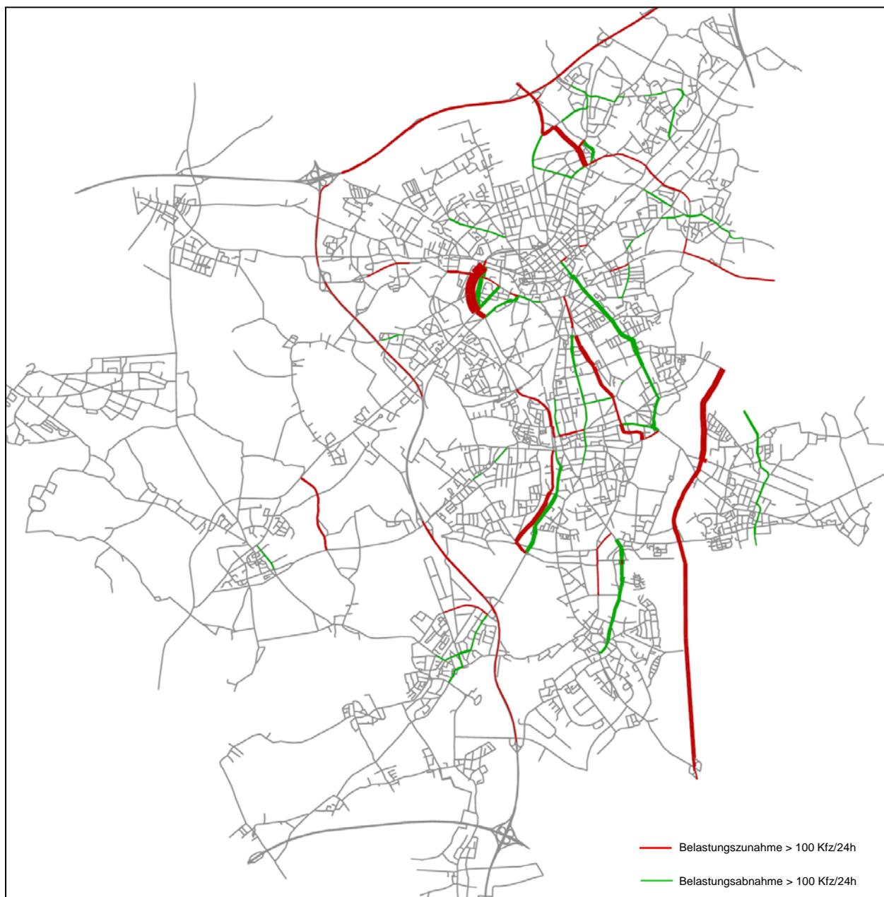
**Bild 51: Qualitatives Differenzbild des durchschnittlichen täglichen Kfz-Verkehrs für das Szenario „Schließung von Netzlücken“ bezogen auf die Ausgangssituation; Beispielstadt Mönchengladbach**
