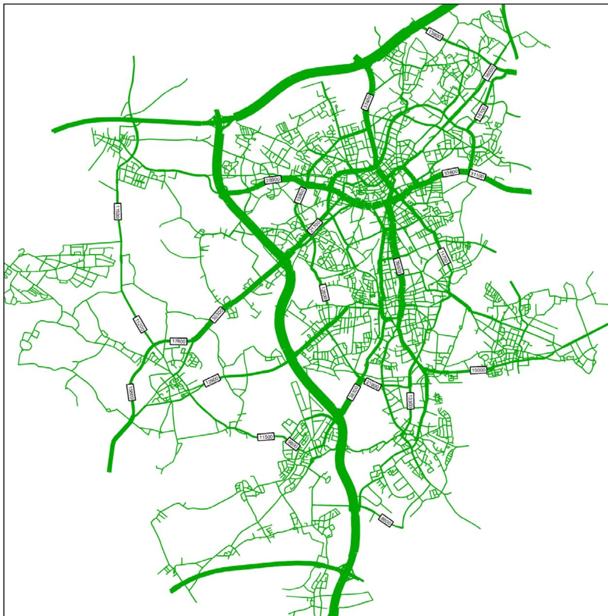
Bild 49: Belastungsbild des durchschnittlichen täglichen Kfz-Verkehrs in der Ausgangssituation; Beispielstadt Mönchengladbach
