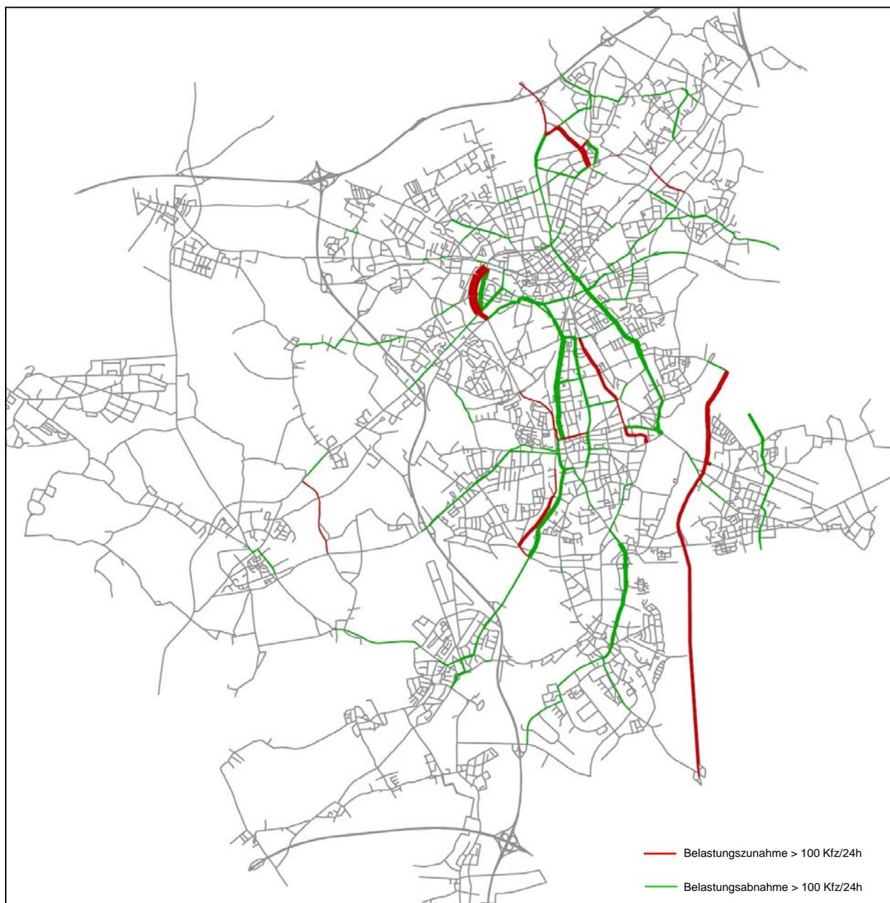
**Bild 61: Qualitatives Differenzbild des durchschnittlichen täglichen Kfz-Verkehrs für das Szenario „Pedelectrisierung“ bezogen auf die Ausgangssituation; Beispielstadt Mönchengladbach**
