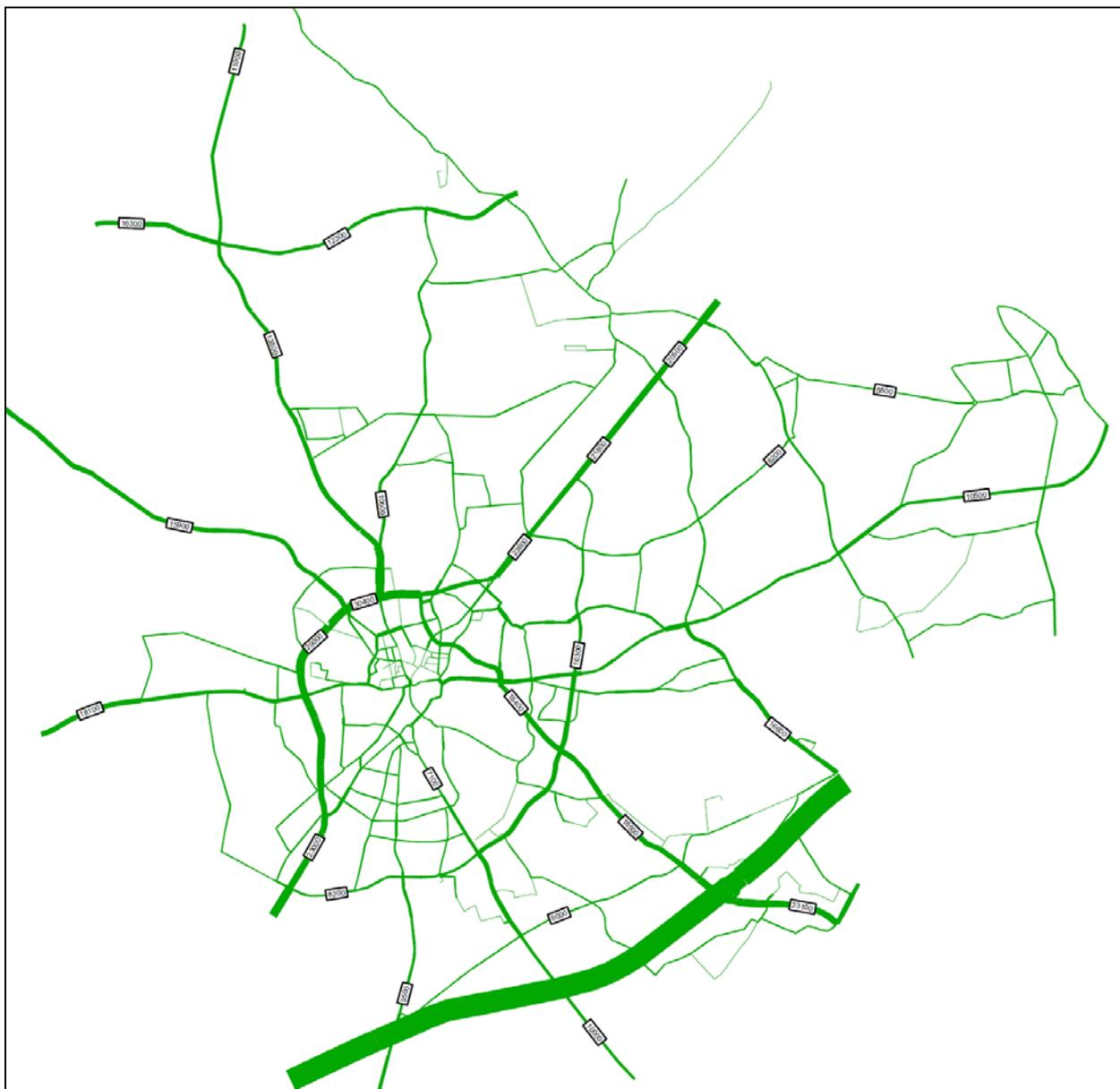
Bild 39: Belastungsbild des durchschnittlichen täglichen Kfz-Verkehrs in der Ausgangssituation; Beispielstadt Gütersloh
