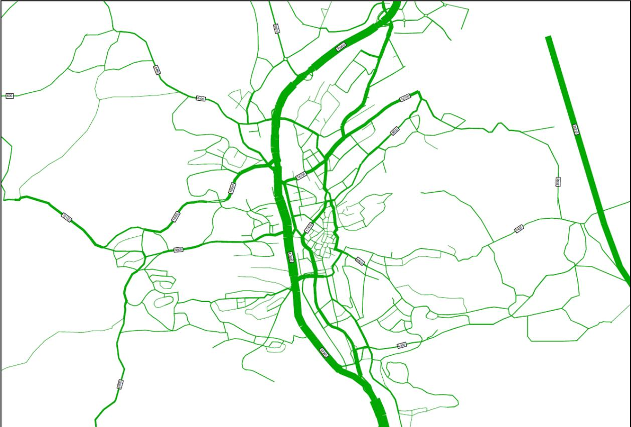
**Bild 47: Belastungsbild des durchschnittlichen täglichen Kfz-Verkehrs für das Szenario „Pedelecsierung am Berg“; Beispielstadt Coburg**
