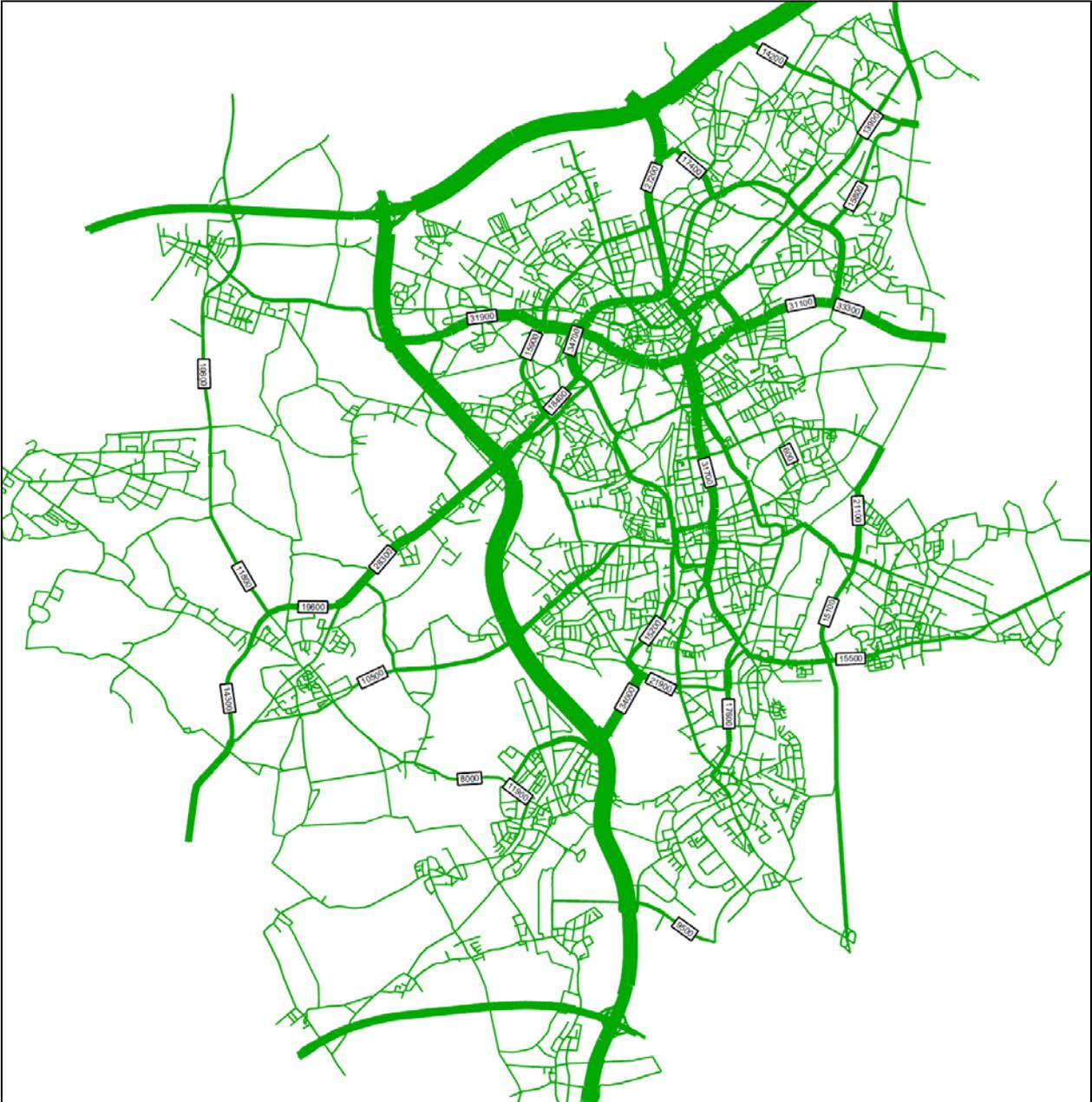
**Bild 58: Belastungsbild des durchschnittlichen täglichen Kfz-Verkehrs für das Zwischenszenario „ÖPNV-Maßnahmen“; Beispielstadt Mönchengladbach**
