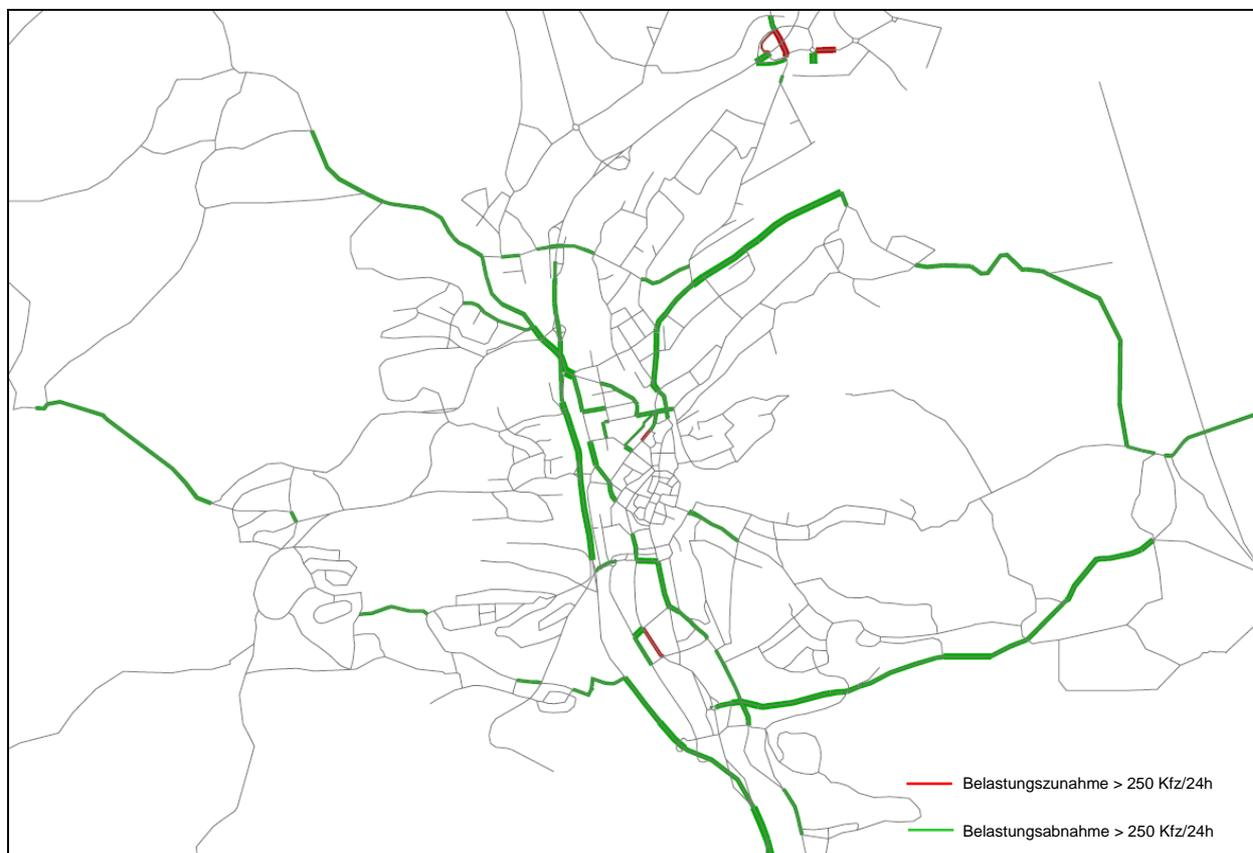
**Bild 46: Qualitatives Differenzbild des durchschnittlichen täglichen Kfz-Verkehrs für das Szenario „Weiche und harte Maßnahmen“ bezogen auf die Ausgangssituation; Beispielstadt Coburg**
