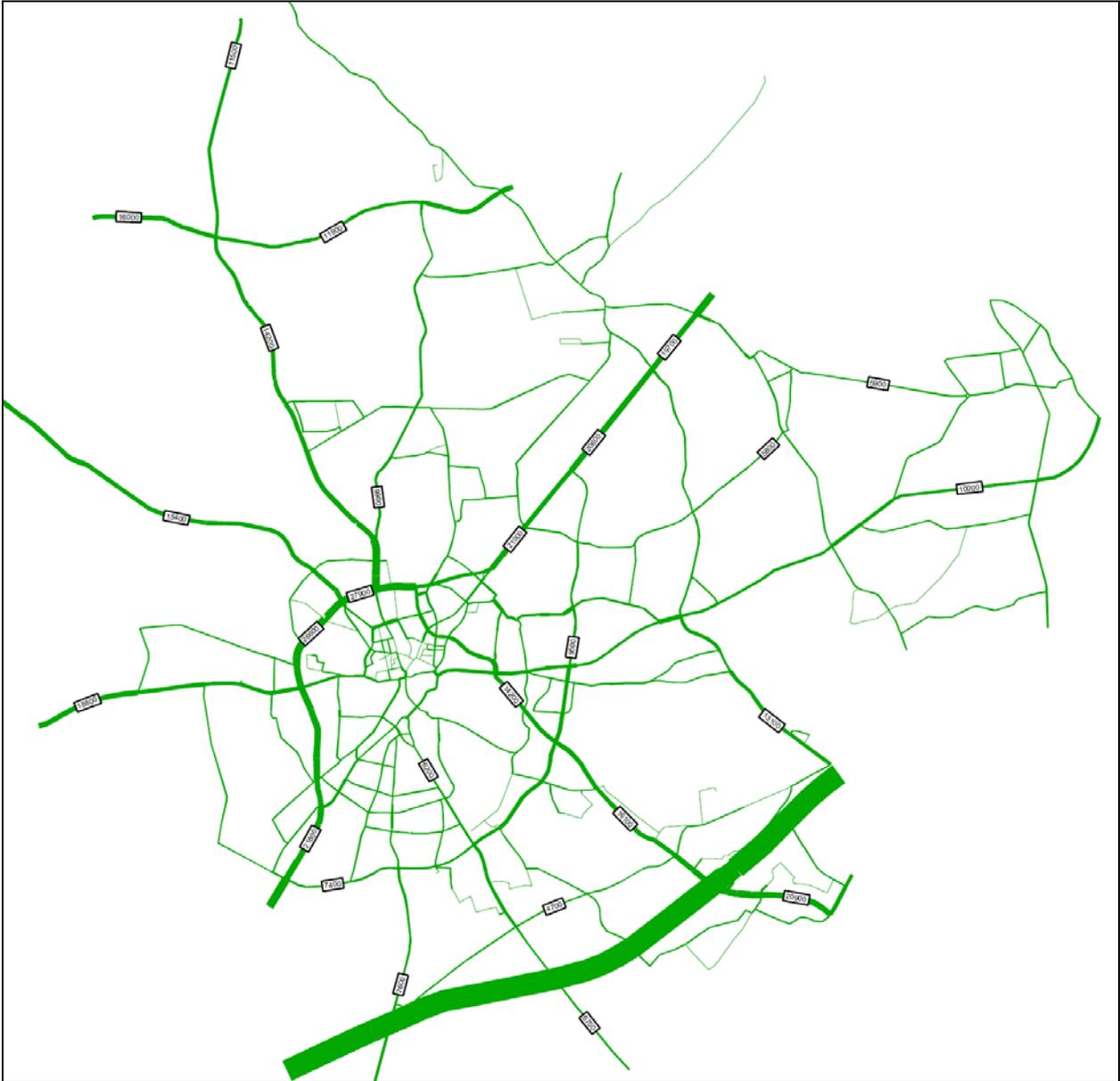
**Bild 40:** Belastungsbild des durchschnittlichen täglichen Kfz-Verkehrs für das Szenario „Weiche und harte Maßnahmen“; Beispielstadt Gütersloh
