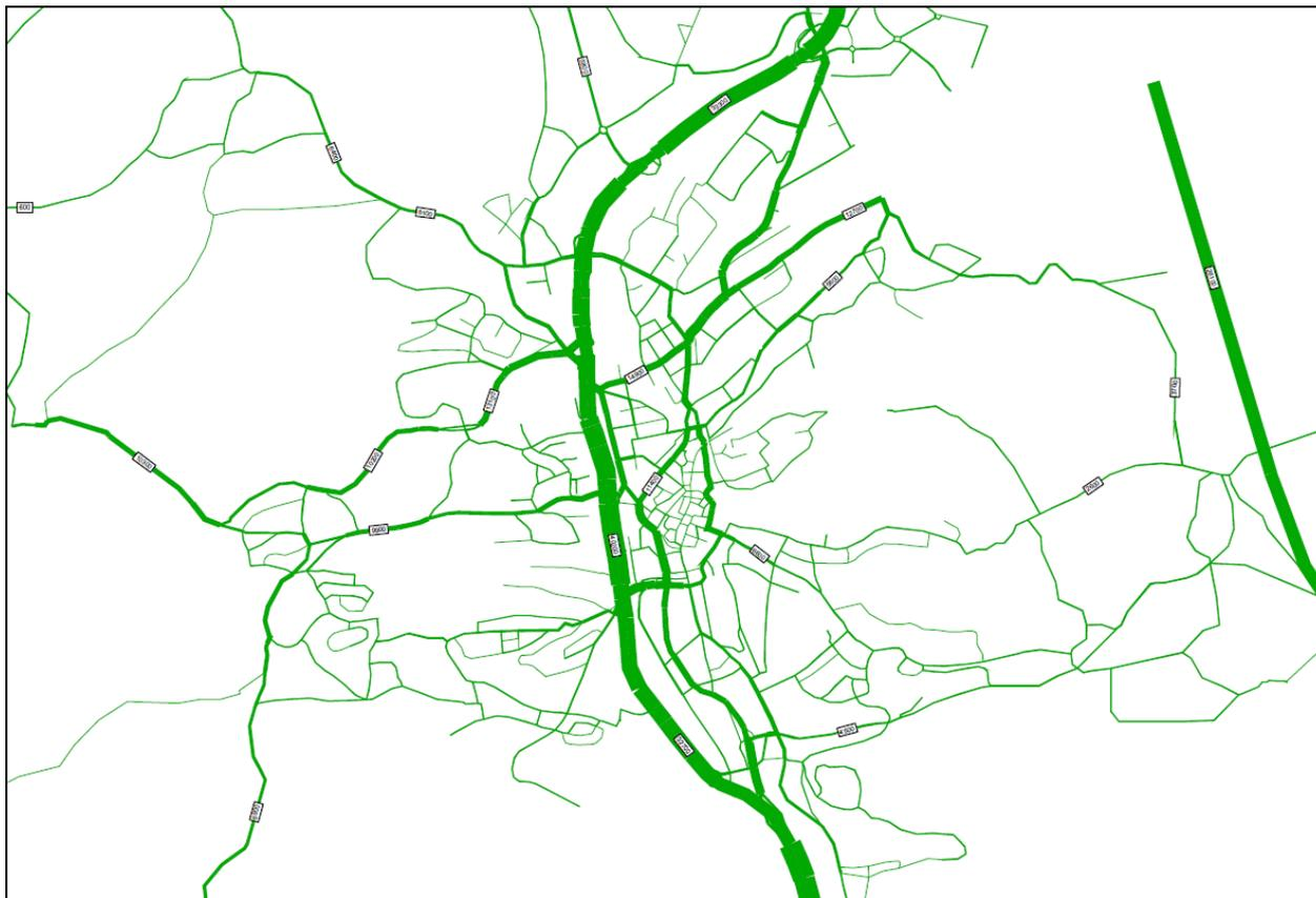
**Bild 45: Belastungsbild des durchschnittlichen täglichen Kfz-Verkehrs für das Szenario „Weiche und harte Maßnahmen“; Beispielstadt Coburg**
