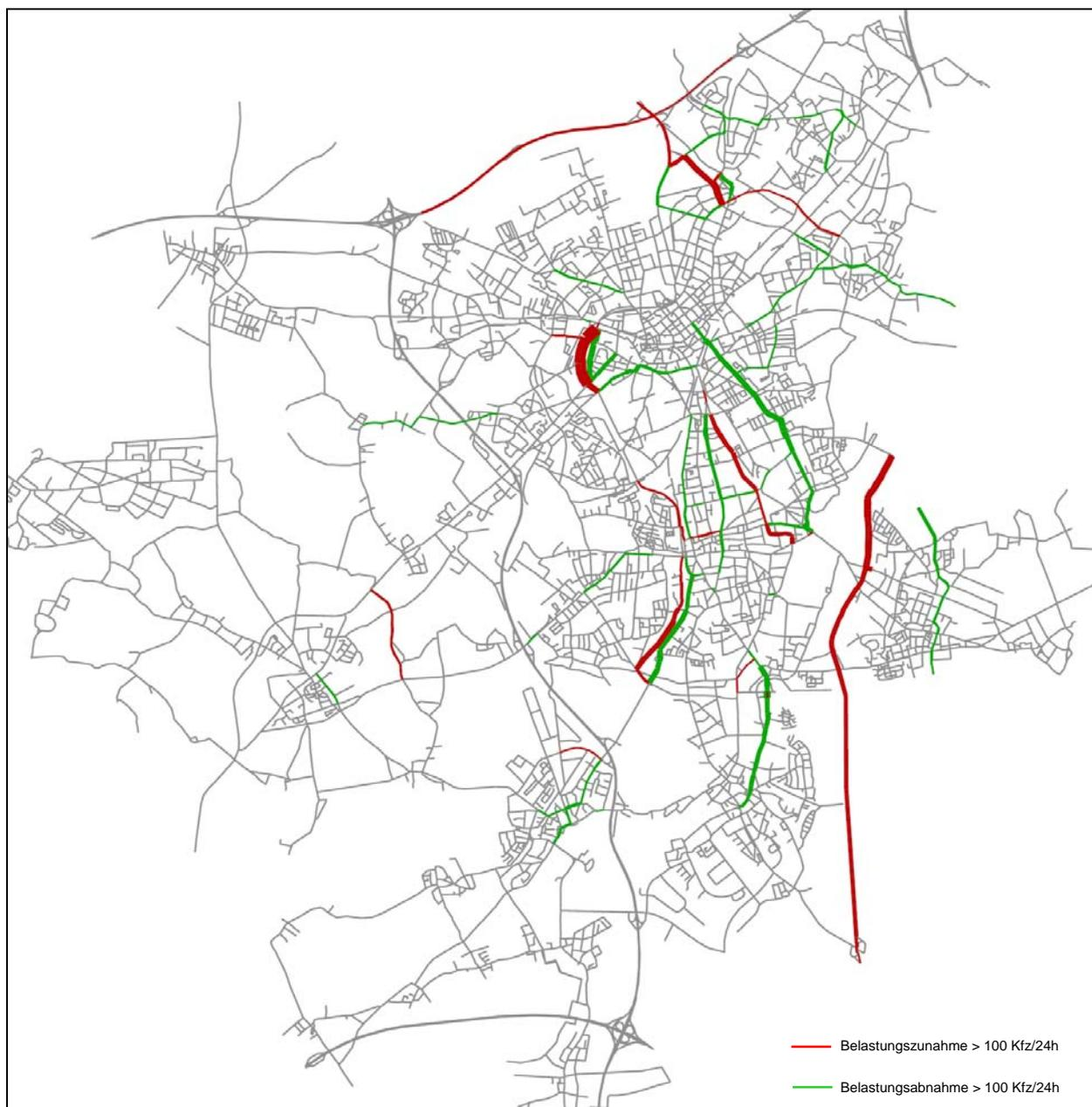
**Bild 55: Qualitatives Differenzbild des durchschnittlichen täglichen Kfz-Verkehrs für das Szenario „Fahrradstraßen“ bezogen auf die Ausgangssituation; Beispielstadt Mönchengladbach**
