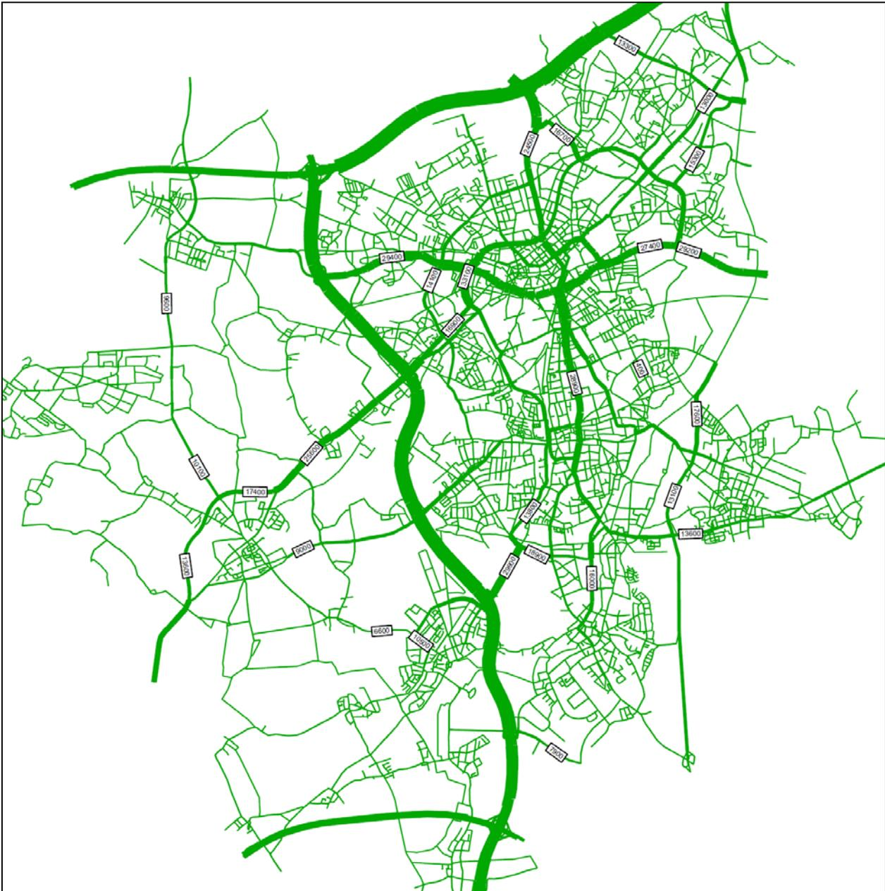
**Bild 60: Belastungsbild des durchschnittlichen täglichen Kfz-Verkehrs für das Zwischenszenario „Pedelelectrisierung“; Beispielstadt Mönchengladbach**
