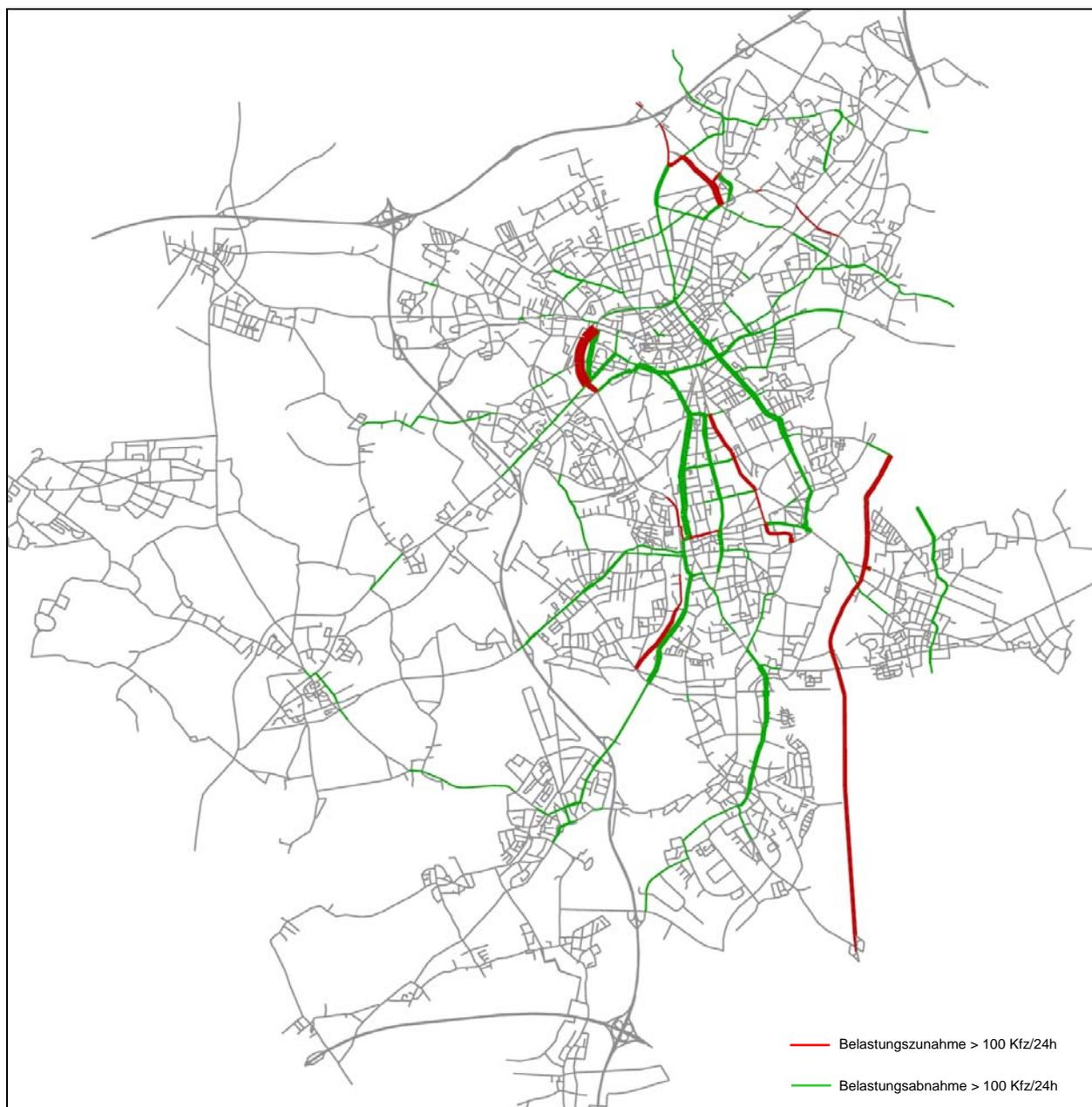
**Bild 65: Qualitatives Differenzbild des durchschnittlichen täglichen Kfz-Verkehrs für das Szenario „bewusste Mobilität +“ bezogen auf die Ausgangssituation; Beispielstadt Mönchengladbach**
