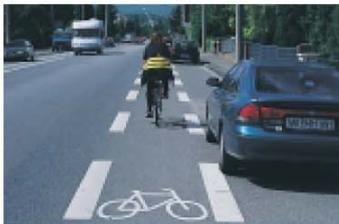
Die **Mitbenutzung von Busfahrstreifen** in Seitenlage durch Radfahrer sollte geprüft werden. Gemeinsam genutzte Sonderfahrstreifen für Linienbusse und Radverkehr, auch „Umweltspuren“ genannt, sparen Fläche und eröffnen die Möglichkeit auch dort den Busverkehr zu fördern, wo die Anzahl der Busse keinen eigenen Busfahrstreifen rechtfertigt.
