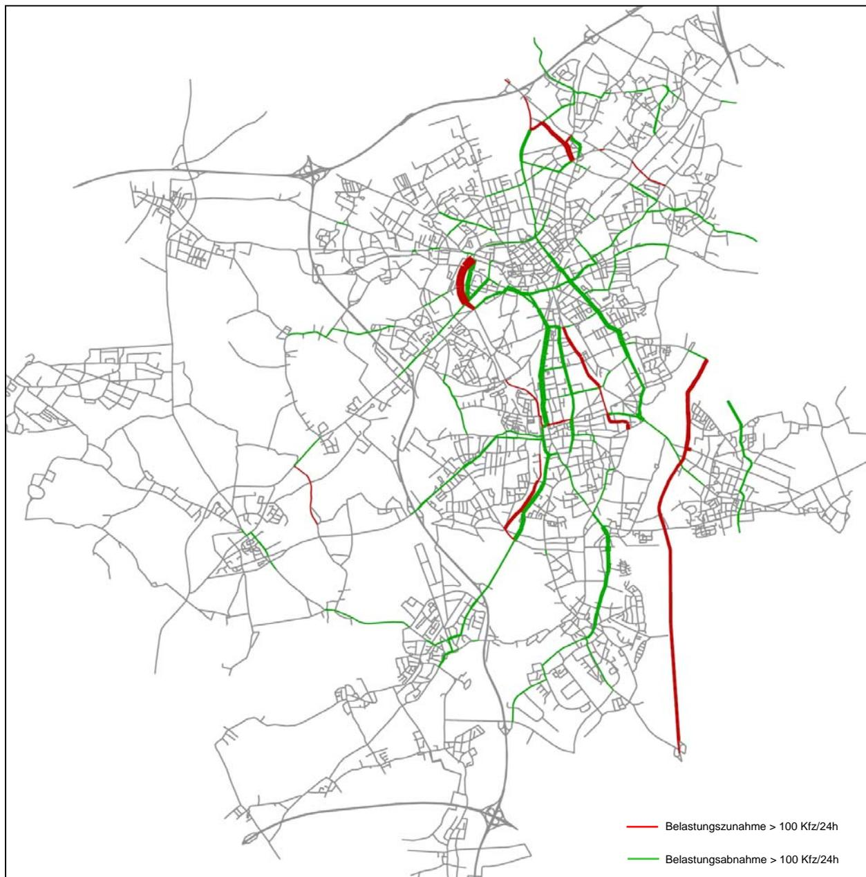
**Bild 63: Qualitatives Differenzbild des durchschnittlichen täglichen Kfz-Verkehrs für das Szenario „bewusste Mobilität“ bezogen auf die Ausgangssituation; Beispielstadt Mönchengladbach**
