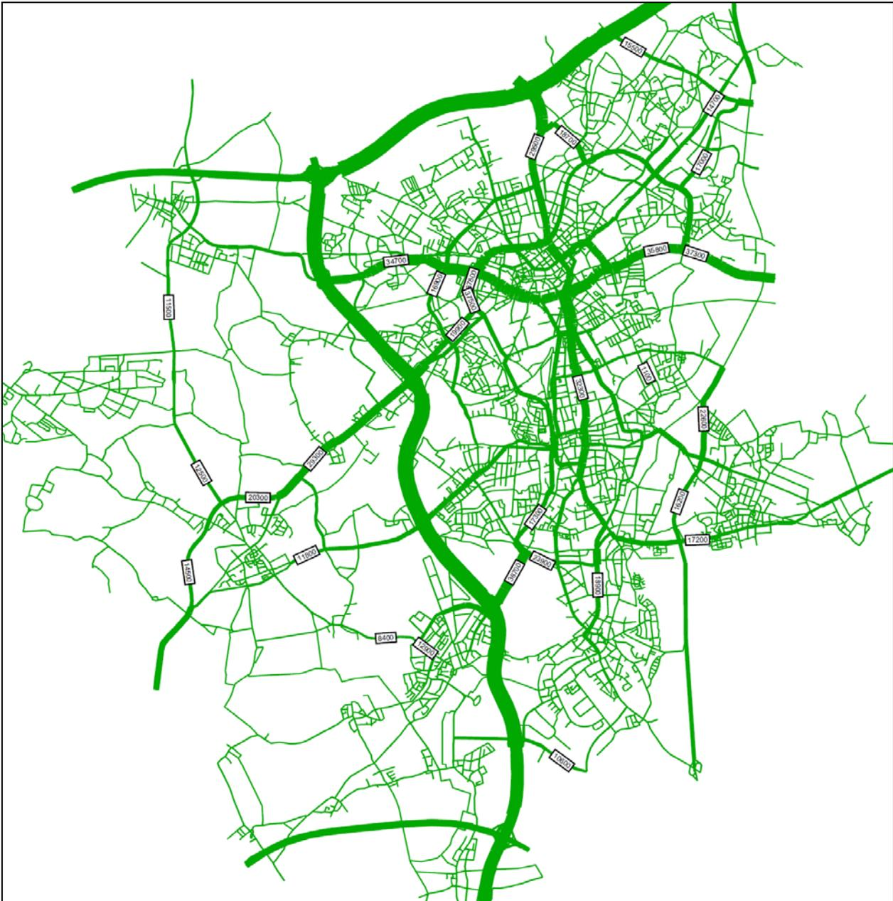
**Bild 50: Belastungsbild des durchschnittlichen täglichen Kfz-Verkehrs für das Szenario „Schließung von Netzlücken“; Beispielstadt Mönchengladbach**
