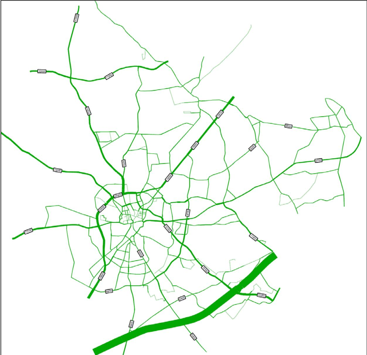
**Bild 42:** Belastungsbild des durchschnittlichen täglichen Kfz-Verkehrs für das Szenario „Pedelelectrisierung“; Beispielstadt Gütersloh
