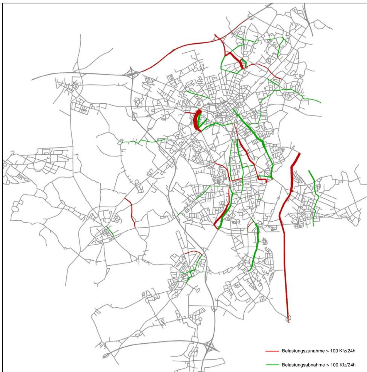
**Bild 53: Qualitatives Differenzbild des durchschnittlichen täglichen Kfz-Verkehrs für das Szenario „Weiche und harte Maßnahmen“ bezogen auf die Ausgangssituation; Beispielstadt Mönchengladbach**
