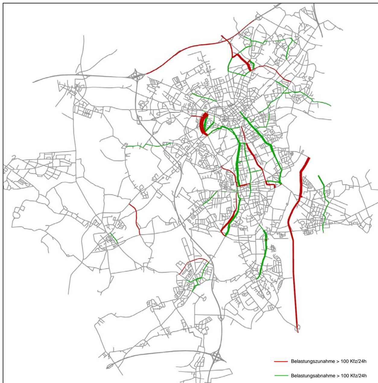
**Bild 57: Qualitatives Differenzbild des durchschnittlichen täglichen Kfz-Verkehrs für das Szenario „Fahrradstraßen +“ bezogen auf die Ausgangssituation; Beispielstadt Mönchengladbach**
