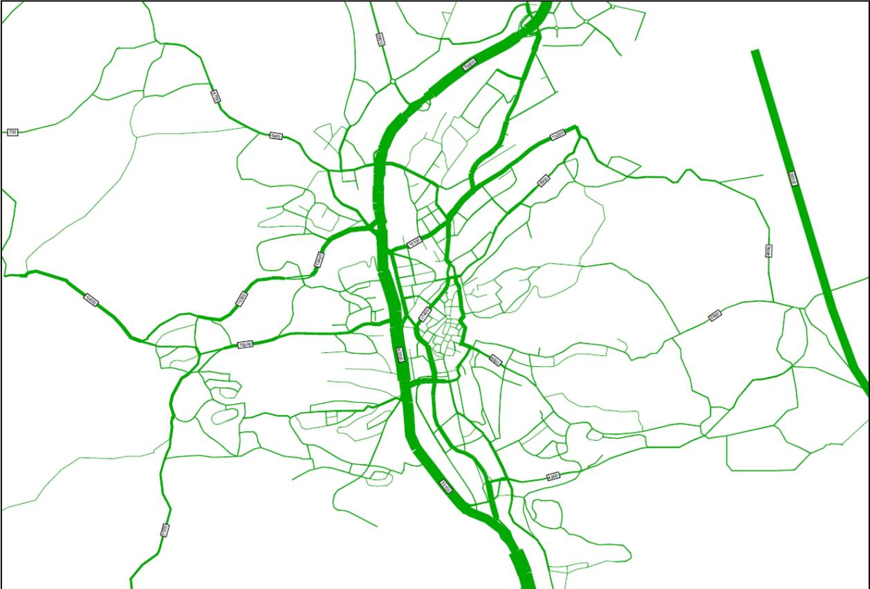
**Bild 44: Belastungsbild des durchschnittlichen täglichen Kfz-Verkehrs in der Ausgangssituation; Beispielstadt Coburg**
