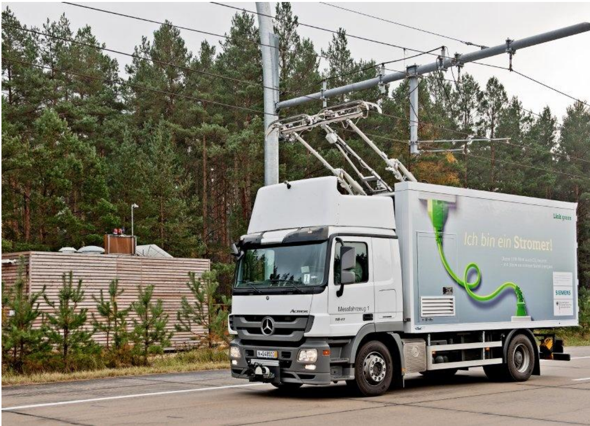
Abbildung 4-5: Hybrid-LKW unter Oberleitung 177
