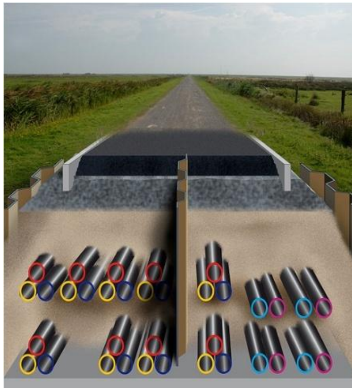
Abbildung 4-2: Leerrohrbauwerk auf Norderney 156
