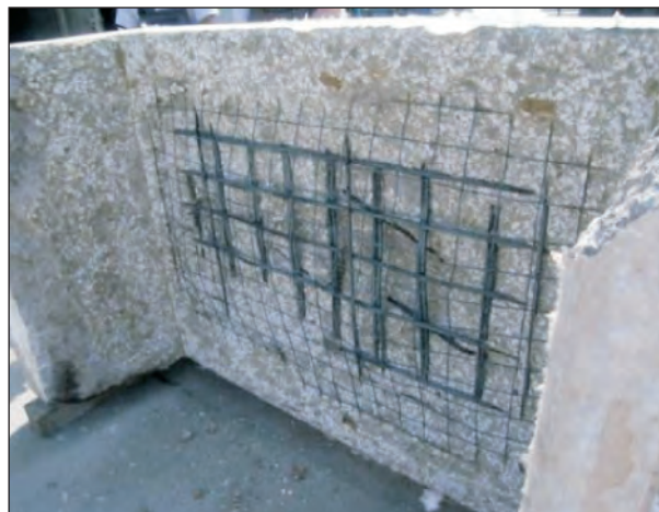
Bild 4: Probekörper aus Referenzbeton (ohne PP-Fasern) nach Großbrandversuch [10]
