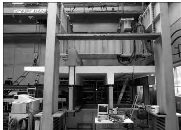
Bild 19: Versuchsrahmen mit eingebautem Plattenbalken
