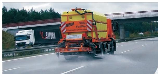
**Bild 11:** Küpper-Weisser – Sprühmaschine „Full Wet“ mit einer eingestellten Sprühdichte von 20 g/m<sup>2</sup> und Sprühbreite von 7,50 m
