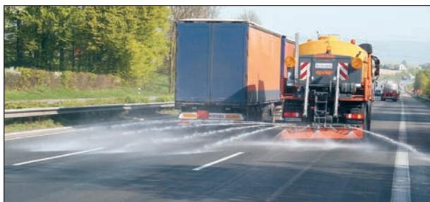
**Bild 10:** Epoke – Sprühmaschine mit einer eingestellten Sprühdichte von 20 ml/m<sup>2</sup> und einer Sprühbreite von 11,00 m
