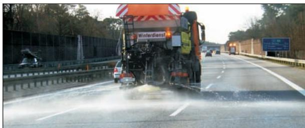
**Bild 9:** Küpper-Weisser – Kombinationsstreumaschine mit einer eingestellten Sprühdichte von 20 g/m<sup>2</sup> und einer Sprühbreite von 11,25 m
