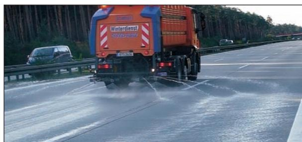
**Bild 12:** Schmidt – Sprühmaschine „Straliq“ mit einer eingestellten Sprühdichte von 40 g/m<sup>2</sup> und Sprühbreite von 11,25 m
