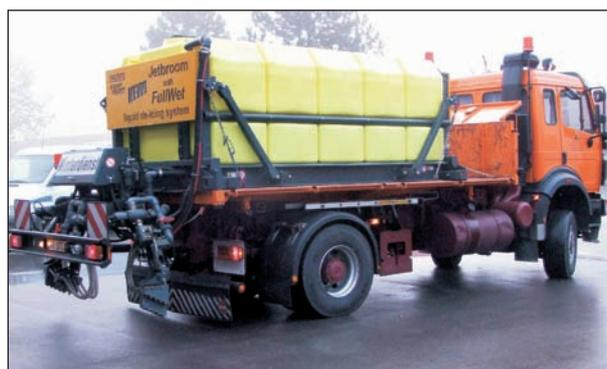
**Bild 14:** Küpper-Weisser – „Full Wet“-Sprühmaschine der Autobahnmeisterei Rottweil
