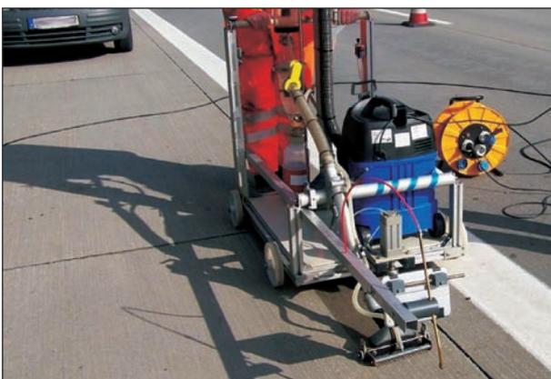
**Bild 6:** Salzaufnahme mit dem Spül-Saug-Gerät
