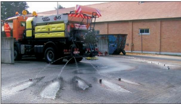
Bild 15: Ausrichtung der Weitstrahldüsen
