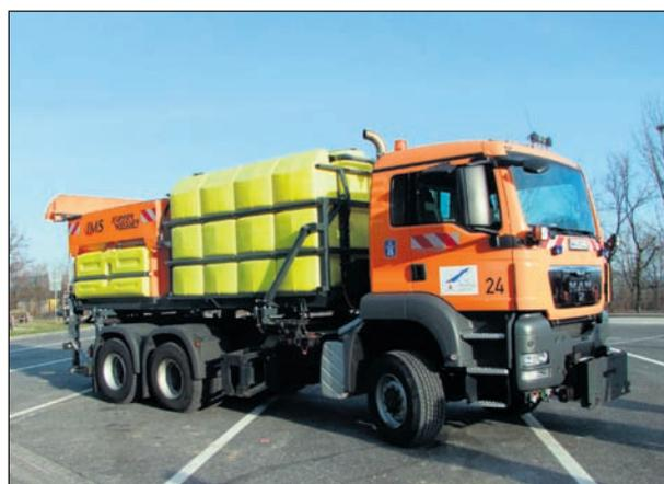
**Bild 13:** Kombinationsstreumaschine von Küpper-Weisser für 10.000 l Salzlösung und 5 cbm Trockensalz
