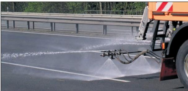
**Bild 18:** Kegelstrahldüsen im Bereich der Fahrzeugbreite, Weitstrahldüsen für Breiten größer 2,50 m
