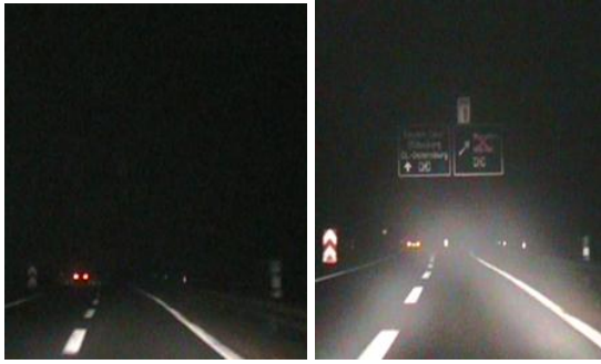
Abbildung 47: Vergleich der Nachtsichtbarkeit (Abblendlicht links, Fernlicht rechts)
