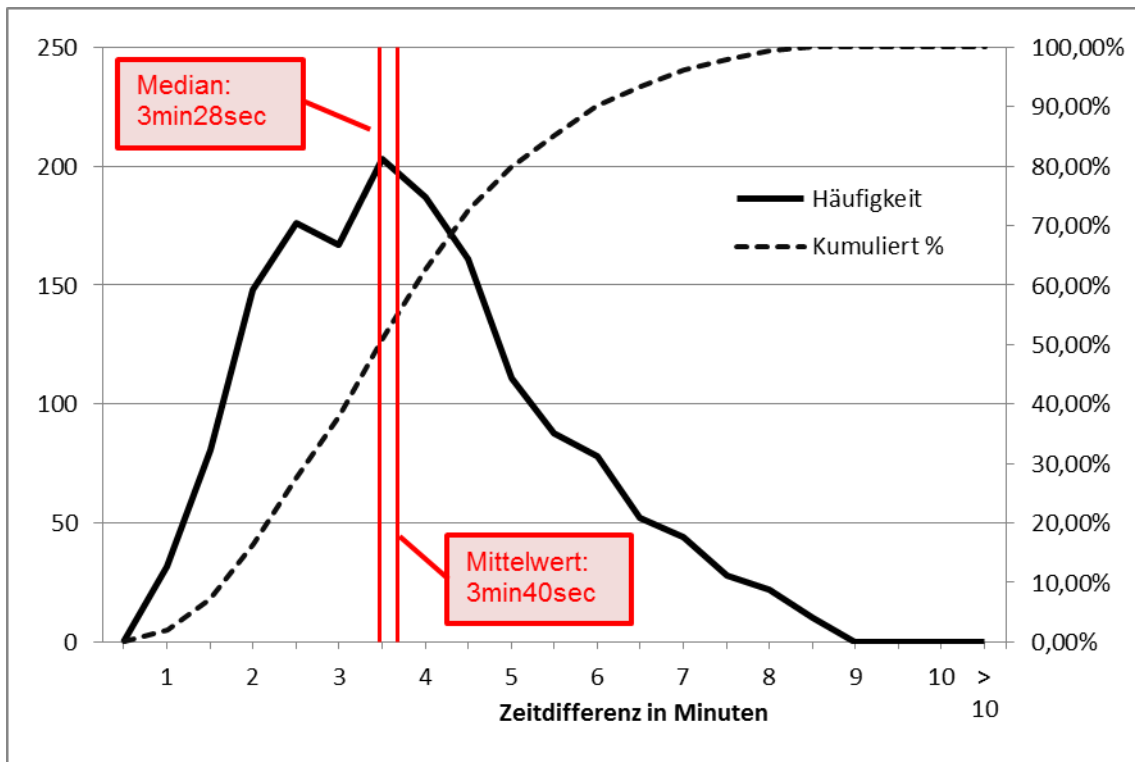
Abbildung 3: Häufigkeiten der Zeitdifferenzen zwischen Notrufeingang und RDS-TMC-Meldungszugang in Minuten (n = 1.588 Ereignisse)
