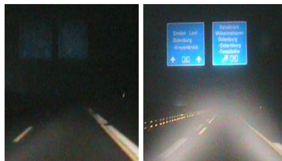
Abbildung 46: Vergleich der Nachsichtbarkeit (Abblendlicht links, Fernlicht rechts) (Überkopfbeschilderung in ca. 50 Metern)
