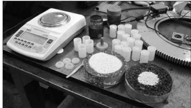
**Bild 43:** Versuchsaufbau für das Sandfleckverfahren
