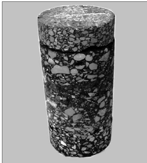
Bild 25: Bohrkern aus einer Fahrbahnbefestigung
