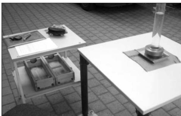
**Bild 50:** Versuchsaufbau für Messungen mit dem Ausflussmesser nach Moore
