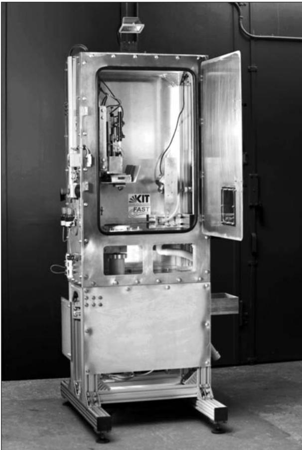
**Bild 20:** Gesamtaufbau des Griffigkeits- und Abriebprüfstandes (GAT)
