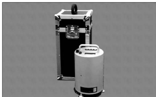
Bild 46: Texturmessgerät ELAtextur® [IWS Messtechnik]
