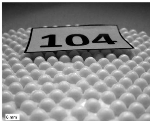
**Bild 40:** Kunstharzabdruck des Probengrundkörpers mit eingepressten Glaskugeln (6 mm)
