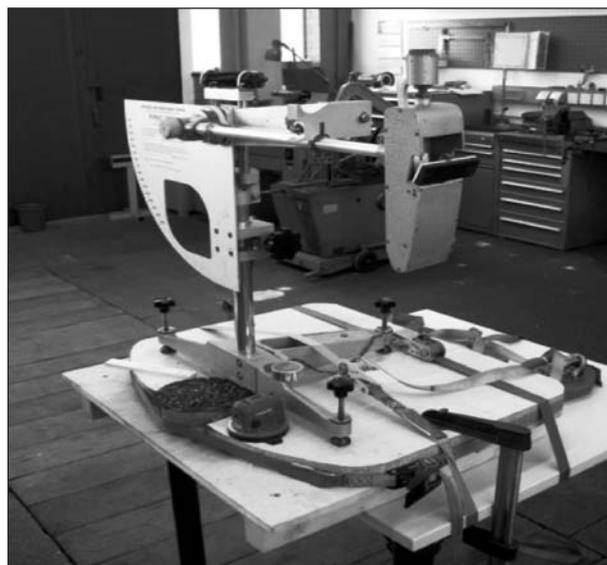
**Bild 56:** Versuchsaufbau des SRT-Pendelversuches
