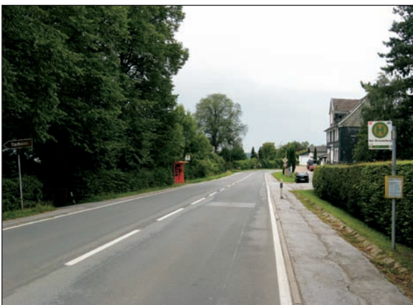
Bild 28: Beispiel einer empfohlenen Überquerungsstelle mit zul. v 70 km/h
