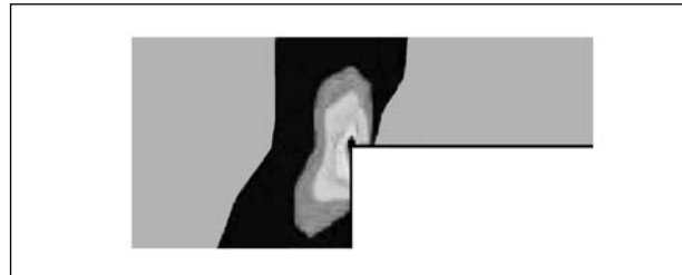
Bild 58: Singularität an eckiger Verbindung (Quelle: ANSYS, Berechnungsmodelle richtig aufbereiten und bewerten)
