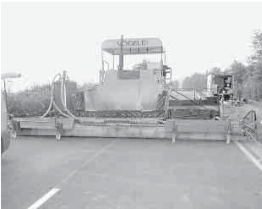
*Modifizierter Asphaltferti-ger für den Einbau offen-porigen Betons mit einer Walzbürste für das gleich-mäßige Aufbringen der Haftbrücke*
