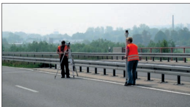
Bild 38: Feinnivellement zur Bestimmung der Durchbiegungen
