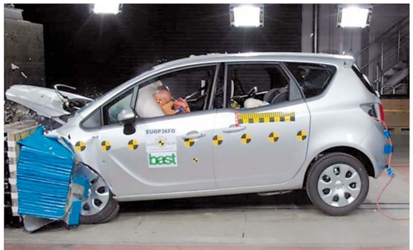
Frontalanprall mit 40 Prozent Frontüberdeckung und 64 km/h Aufprallgeschwindigkeit gegen eine deformierbare Barriere
