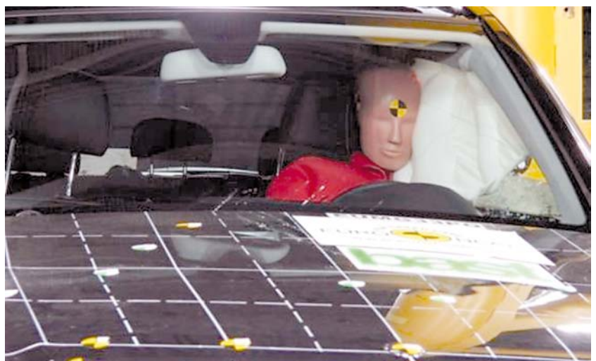
Seitlicher Pfahlanprall mit 29 km/h
