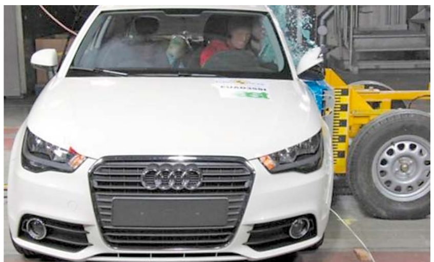
Seitlicher Barrierenanprall mit 50 km/h
