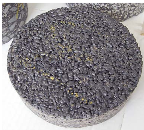
Oberfläche eines PMA-Bohrkerns, Durchmesser 150 Millimeter
