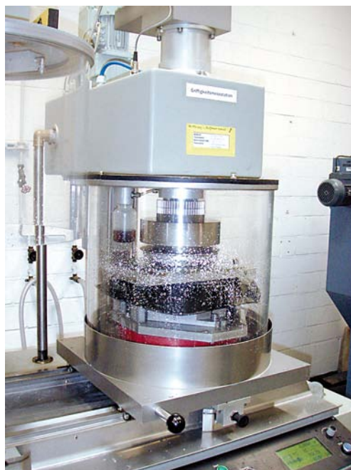
Impedanzrohrmessung, Griffigkeitsuntersuchungen mit dem SRT-Pendel und Untersuchungen mit dem Wehner/Schulze-Verfahren (von oben nach unten)
