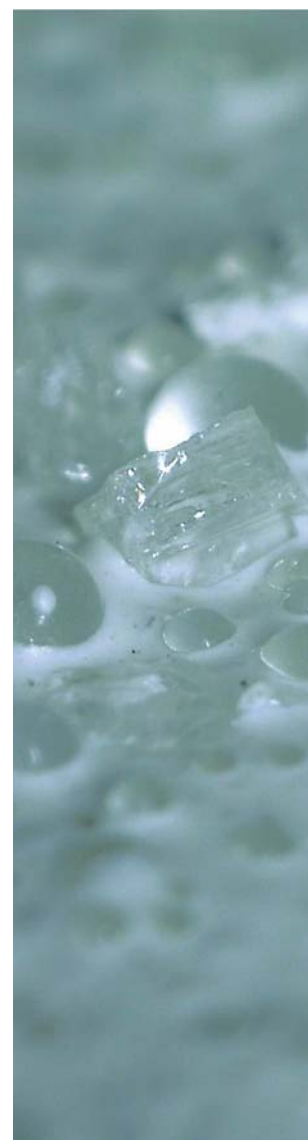
Reflexperlen und Griffigkeitsmittel im Markierungsstoff (Thermoplastik)
