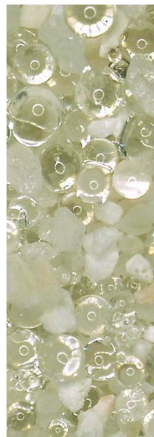
Reflexperlen und Griffigkeitsmittel in einer Nachstreumittelmischung
