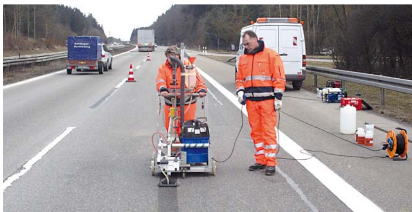
Spül-Saug-Gerät bei der Messung der Liegedauer von Tausalzen auf der Fahrbahn
