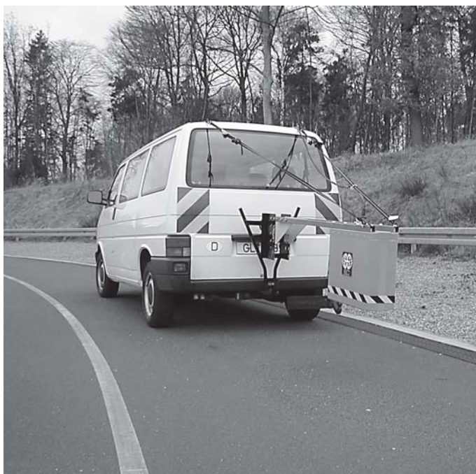
Georadarmesssystem der BASt
