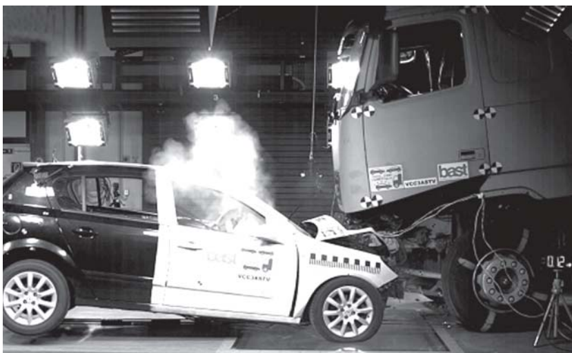
Mittelklasse-Fahrzeug bei einem Aufprall gegen ein Front-Unterschuttsystem eines Lkws
