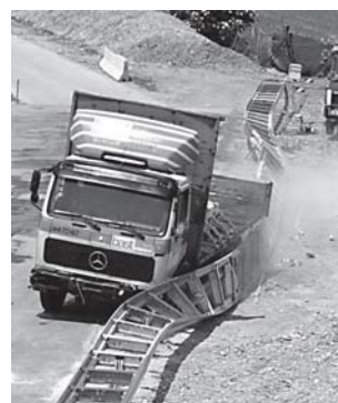
Anprallprüfung an eine Schutzeinrichtung
