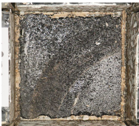
Bild 7: Abichtungssystem 2-1, Bruchart, Ansicht Probekörper
