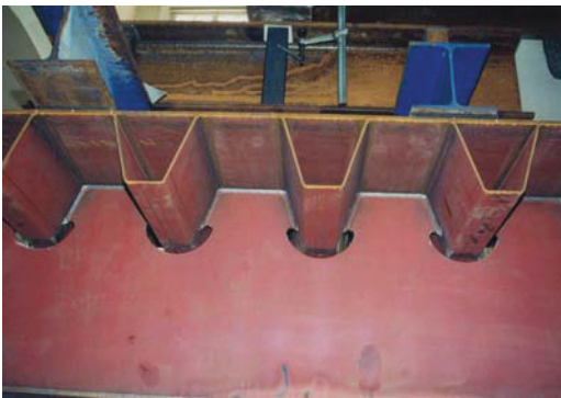
Bild 1: 9,0 m langer QTR- Probekörper der Karlsruher Untersuchungen
