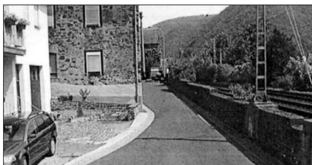
Bild 25: Ursachen für Engstellen – bedingte Engstelle durch eine Bahntrasse und ein Gebäude
