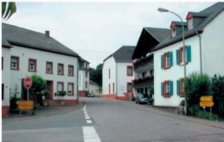
Bild 108: Aufgeweiteter Annäherungsbereich einer Engstelle
