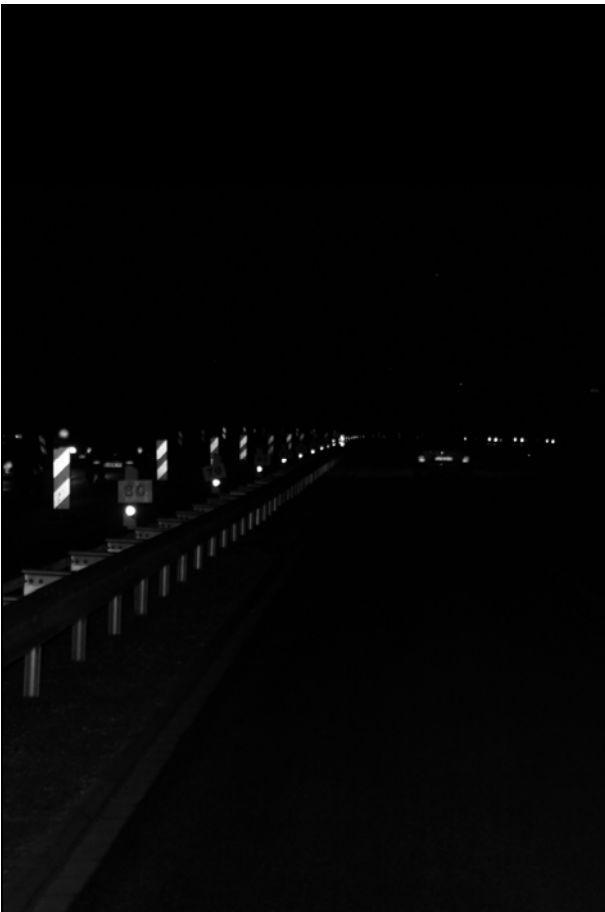
Bild 7.34: Leitfahnen aus ca. 90 m Entfernung im Dunkeln
