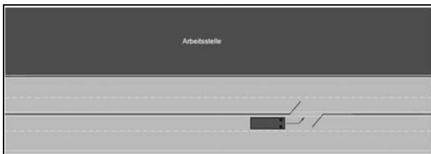
Bild 7.4: Variante A – Notöffnung innerhalb der Baustelle
