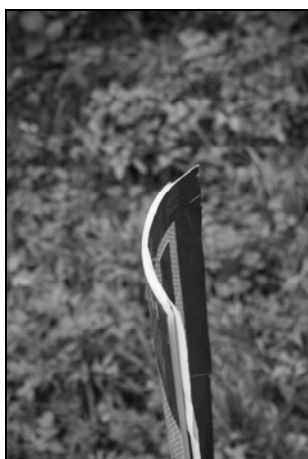
Bild 7.37: Wölbung der Kunststoff-Fahnen
