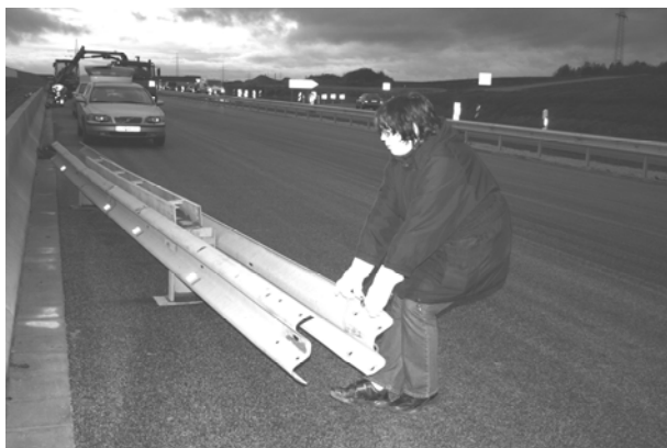
Bild 7.15: Versuche mit Testpersonen zum maximalen Kraftaufwand bei Verschieben einer Notöffnung
